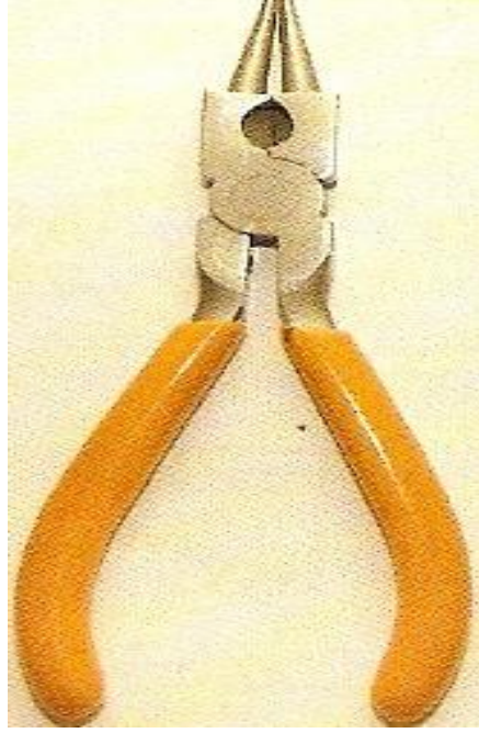
Şekil 4. Yuvarlak uçlu pense (Halka Kıvrırma Aleti)
