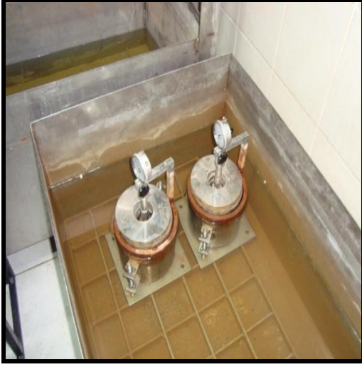
Şekil 3.8. Kür havuzunda bekletme
