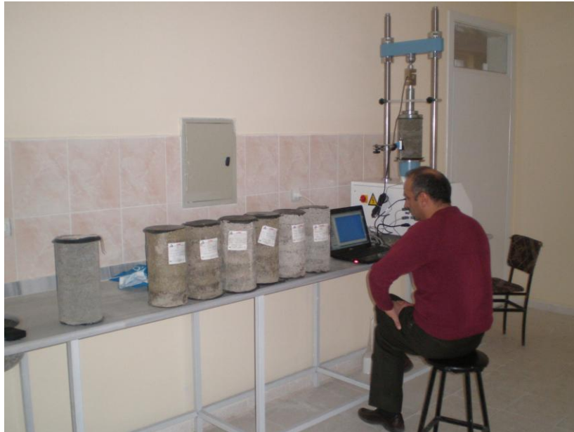
Şekil 5.12. Serbest Basınç Deneyi Numuneleri
