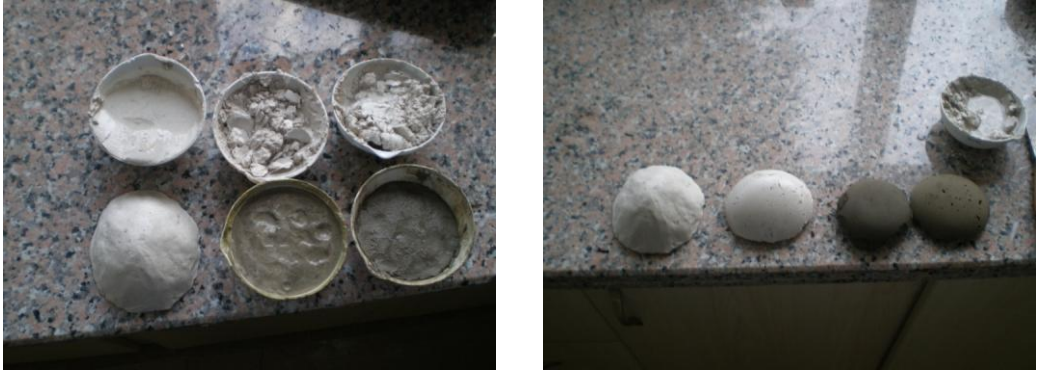
Şekil 3.5. Silis dumanı ve fosfojipsin priz alması
