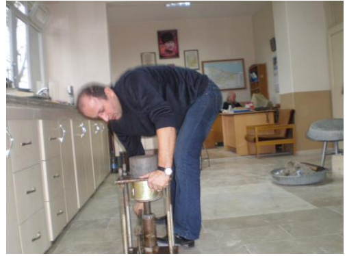
Şekil 3.4. Karışımların hazırlanması ve kompaksiyon
