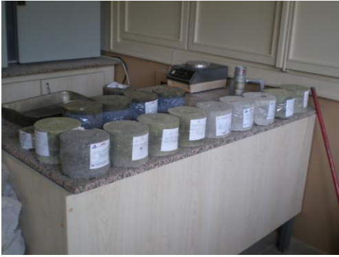
Şekil 3.4. Karışımların hazırlanması ve kompaksiyon
