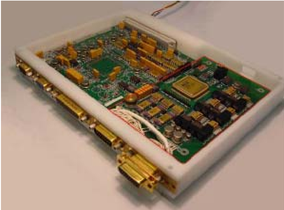
Şekil 5.13 : NASA' nın THEMIS uzay aracında kullandığı FPGA tabanlı fluxgate.
