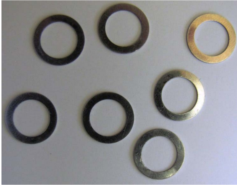
Şekil 7.5 : Sensör nüvesinde kullanılan süpermalloy yapraklar.
