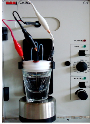
Şekil 3.4: Elektrokimyasal çalışma istasyonuna bağlı üçlü elektrot sistemi
