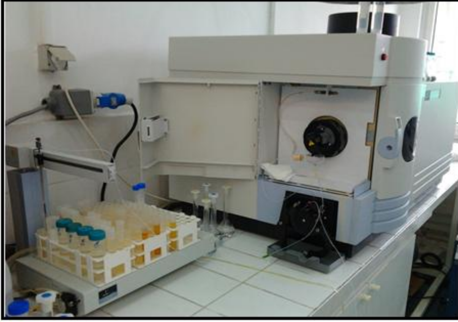
Şekil 3.1. Perkin Elmer Marka Optima 2100 DV OES (Optical Emission Spectrometer) Cihazı
