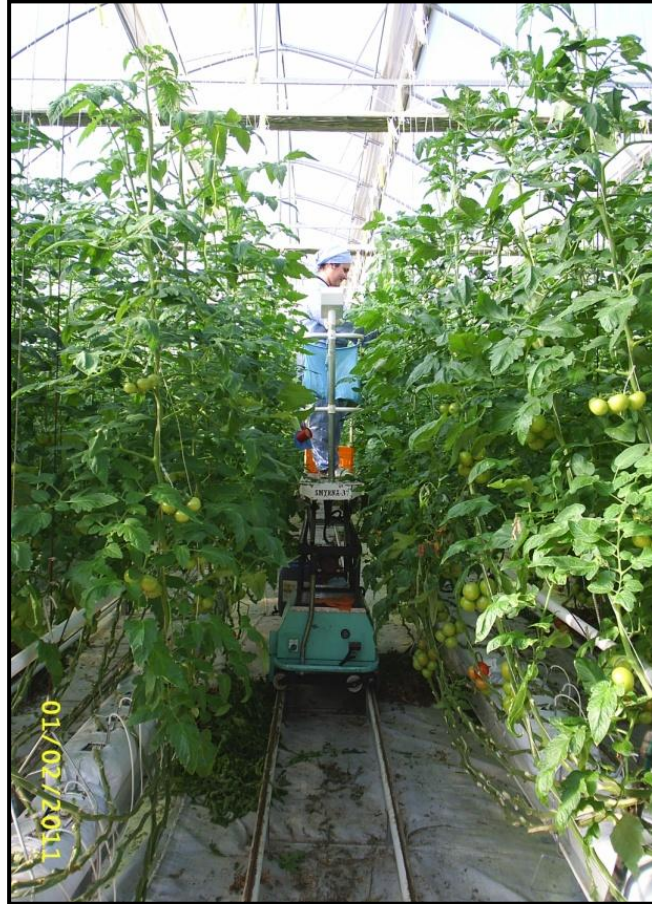
Fotoğraf 80: Raylı Sistemde Yüksekliği Ayarlanabilen Toplama Araçları (Antalya)
