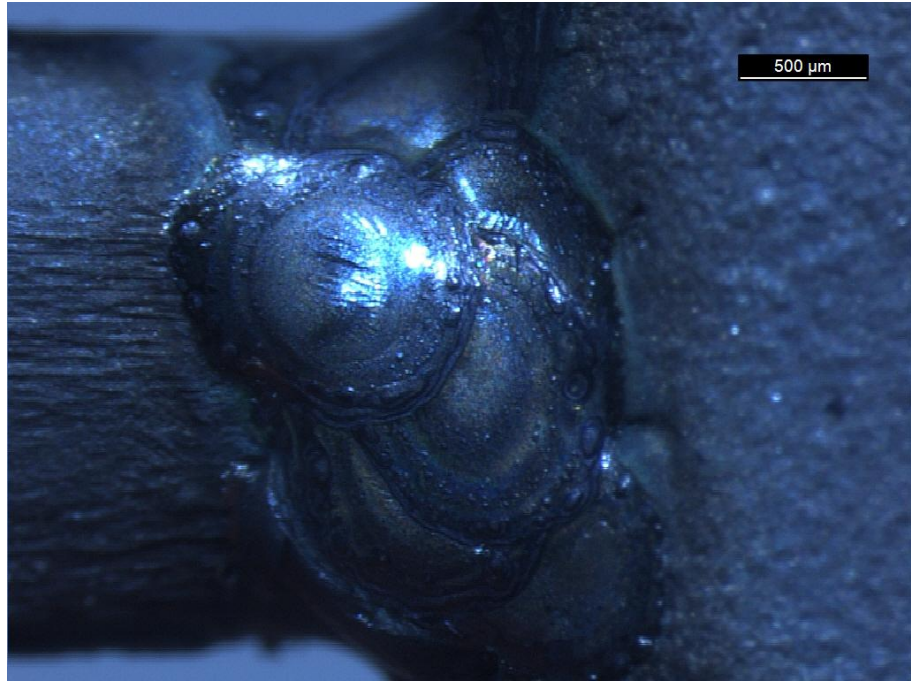
Şekil 4.8. Lazer kaynak bölgesinin doldurucu metal uygulandıktan sonra 40X büyütmede görüntüsü (Wiroweld, Bego GmbH & Co, Almanya).
