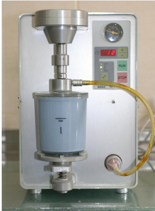
Şekil 3.4. Alçı karıştırmada kullanılan vakum cihazı
