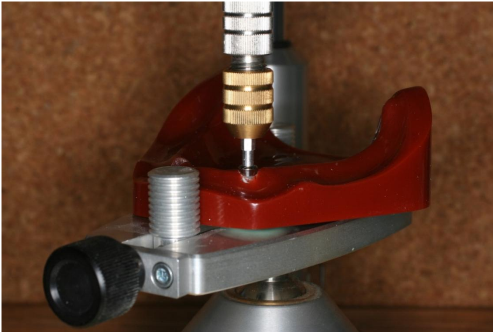
Şekil 3.2. İmplantların paralelometre ile epoksi rezin ana modele yerleştirilmesi.
