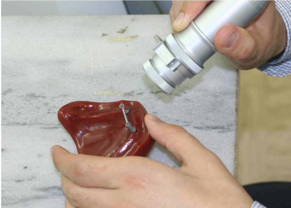
Şekil 3.12. Lazer kaynak işleminin uygulanması
