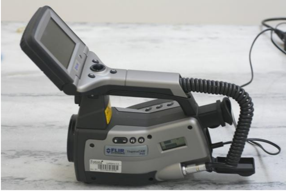
Şekil 3.15. Lazer kaynak işlemi sırasında sıcaklık artışını ölçmek için kullanılan termal kamera
