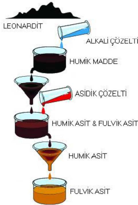
Şekil 3.1. Leonarditten humik ve fulvik asit elde edilmesi (Anonymous 2009)
