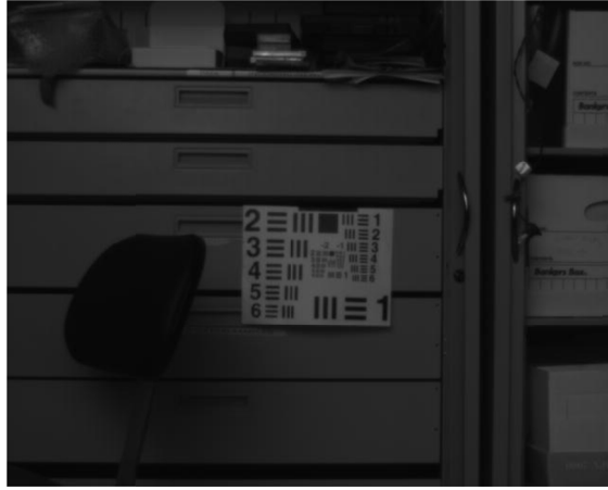
Şekil 1.3. (b) Karanlık akım düzeltilmemiş dedektör
