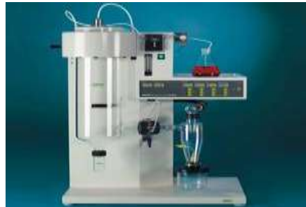
Resim 2. Püskürterek kurutan granülatör (Buchi B-290)
