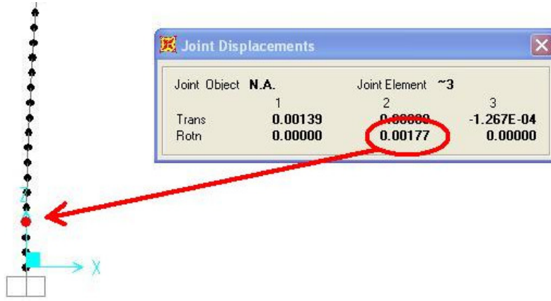
Şekil 2.22: Hedef yerdeğiştirme için plastik mafsalda oluşan radyan dönme.
