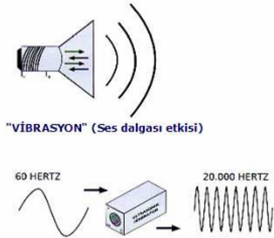
Şekil 2.7 Ses ötesi dalgaların oluşum mekanizması (Cordemans 1991)
