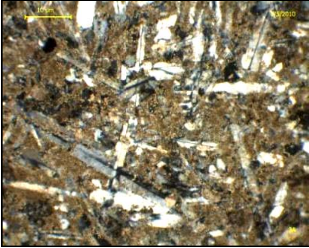
Şekil 4.2 Çamtepe köyü kuzeyinde yüzeylenen jipslerde karbonat malzeme içinde gelişmiş prizmatik cubuksu itici/kavucu karakterli iine
