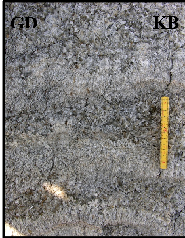
Şekil 3.38 Aratepe ocağında gözlemlenen çimsi jipsler ve kırıntılı birimlerin ardalanması (G'ye bakış)
