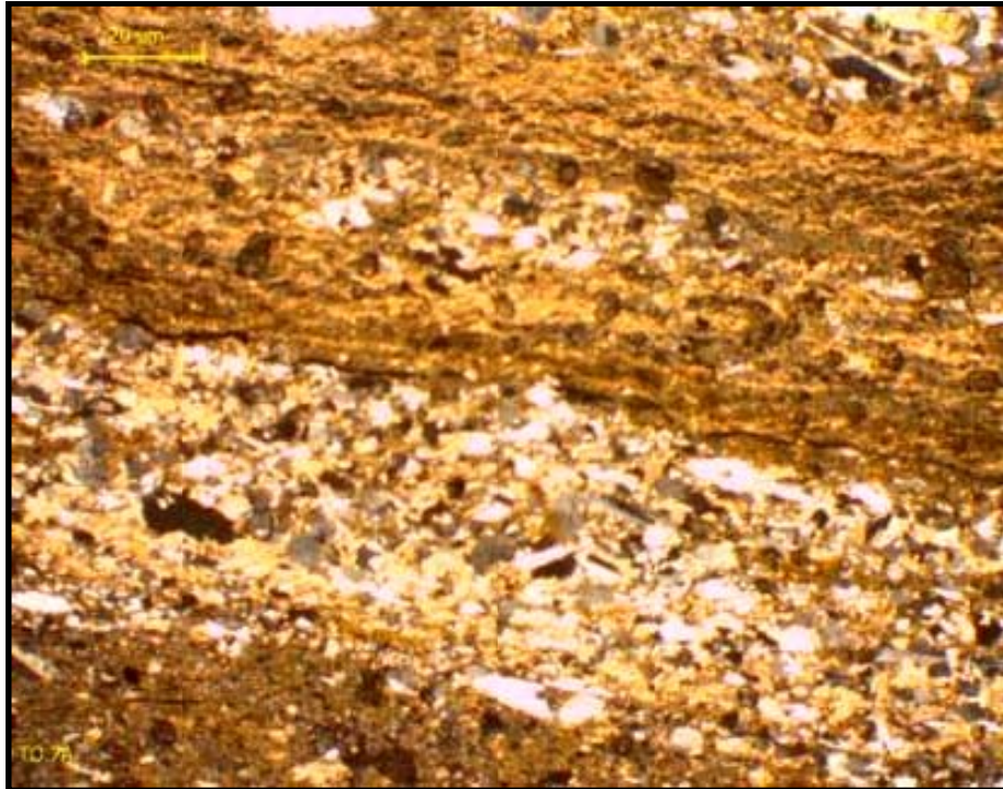
Şekil 4.8 Laminallı jipslerde gözlemlenen balatino doku (kalsit-jips-kalsit ardalanması (Ç.N=Çift Nikol))
