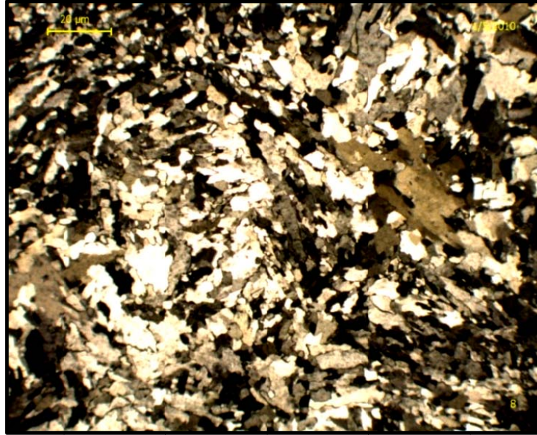
Şekil 4.4 Alabastrin dokulu jipslerde tespit edilen tip 2 türü hidratasyon dokusu.
