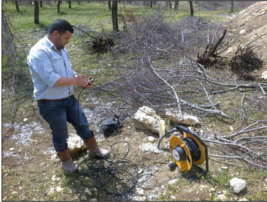
Fotoğraf 2.13 İnklinometre okumasının yapılışı
