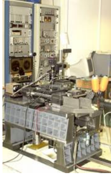
Şekil 5.6 INSA'da bulunan pim-plaka tribotest düzeneği
