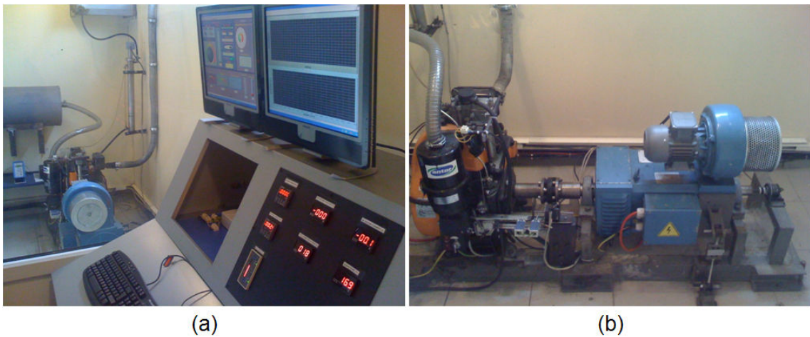
Şekil 5.1 (a) Kontrol paneli ve (b) Diesel motor test düzeneği
