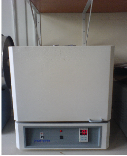
Şekil 3.2 Ankara Üniversitesi, Mühendislik Fakültesi, Fizik Mühendisliği Bölümü, İleri Malzemeler Araştırma Laboratuvarında bulunan, Kutu Tipli Fırın
