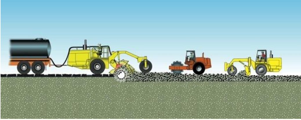
Şekil 5.11 Tam derinlikli geri dönüşümde ufalama ve rutubetlendirme [30]
