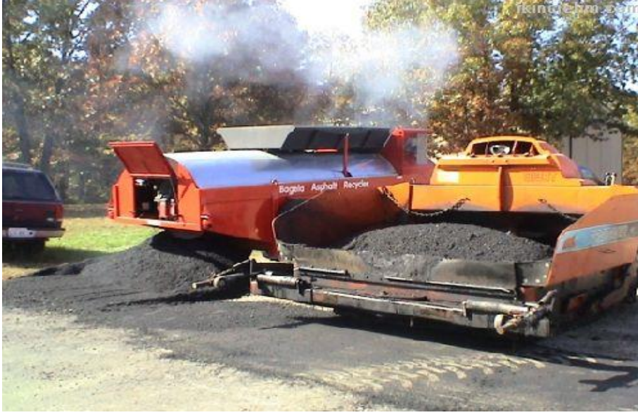
Şekil 4.2 Yerinde geri dönüşüm [16]
