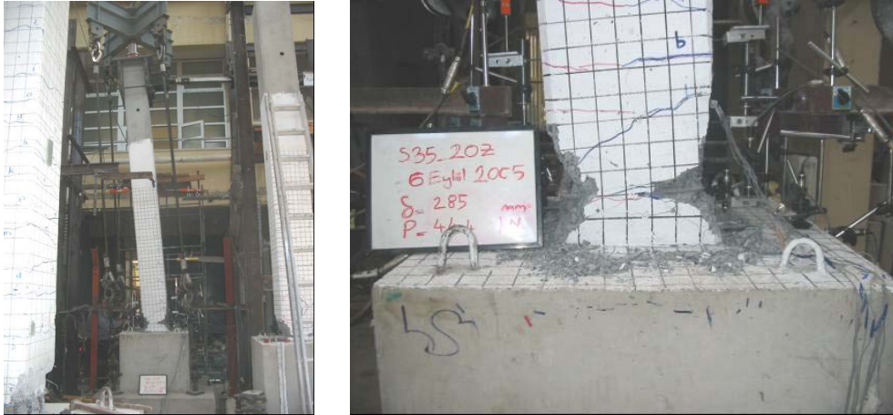
Şekil 4.45 : S35_20Z numunesine ait hasar fotoğrafları.
