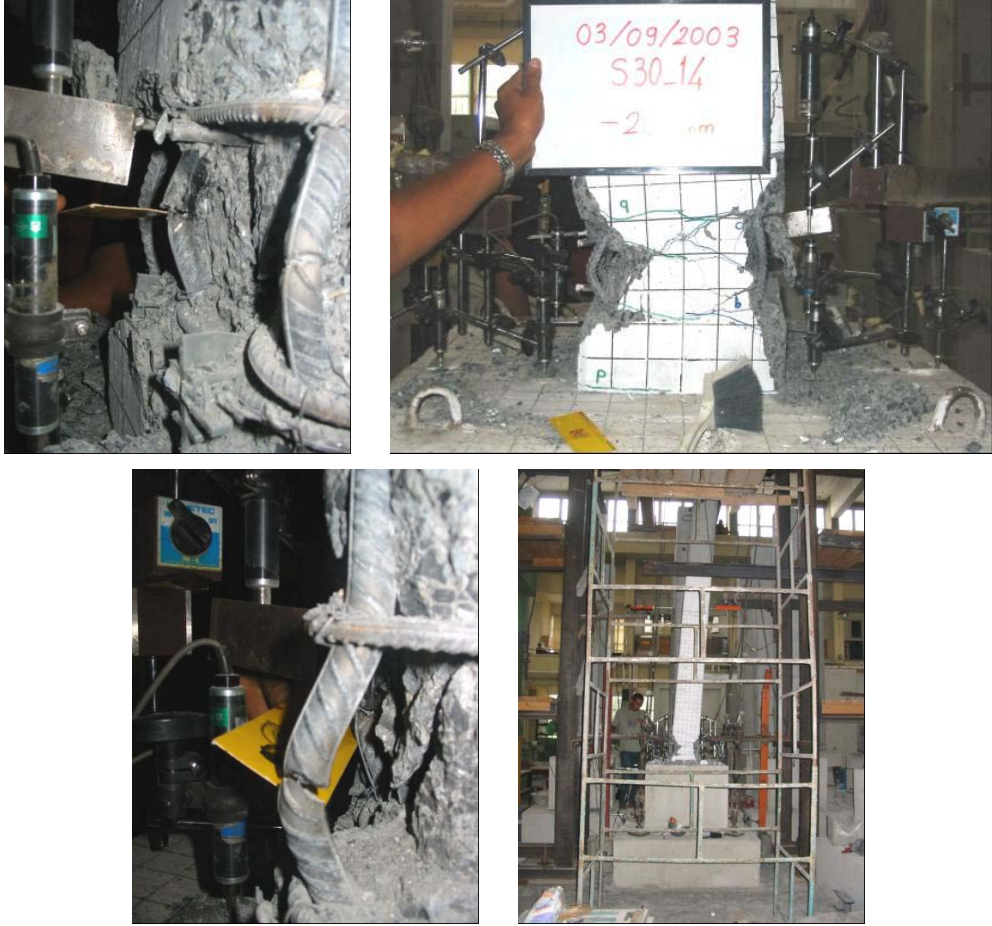
Şekil 4.10 : S30_14 numunesine ait hasar fotoğrafları.
