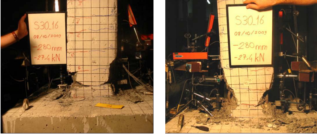
Şekil 4.19 : S30_16 numunesine ait hasar fotoğrafları.
