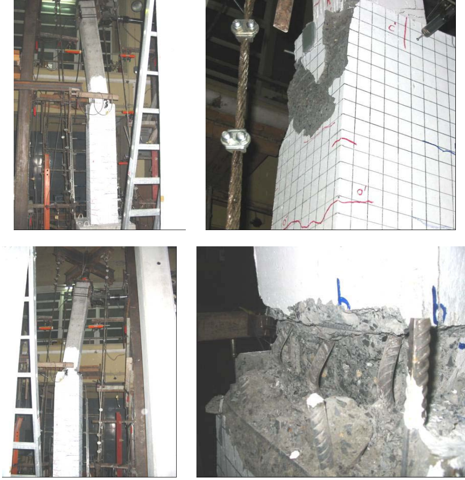
Şekil 4.82 : SR30_14M numunesine ait hasar fotoğrafları.
