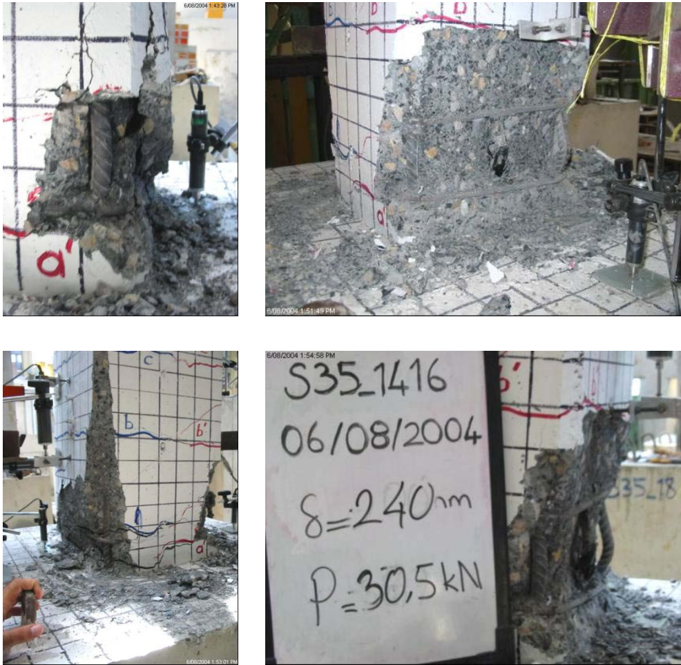
Şekil 4.32 : S35_1416 numunesine ait hasar fotoğrafları.
