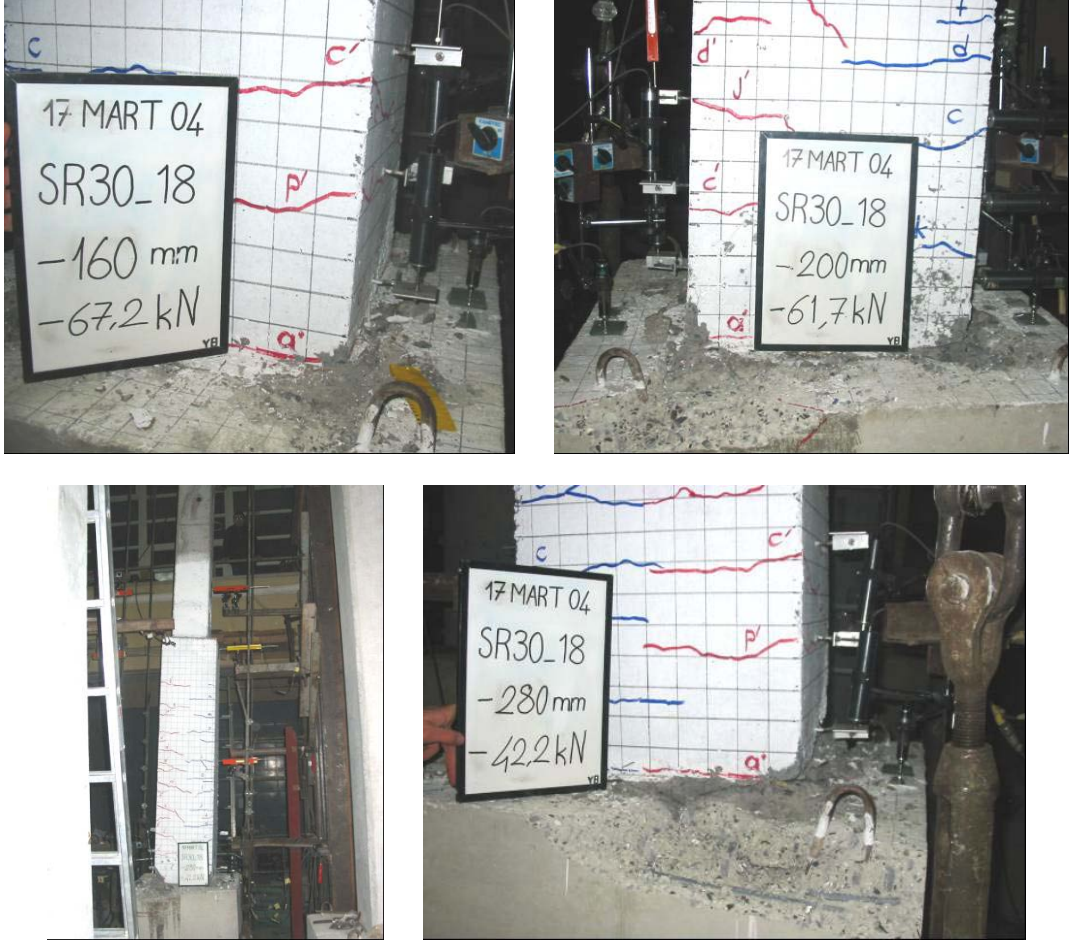
Şekil 4.92 : SR30_18 numunesine ait hasar fotoğrafları.
