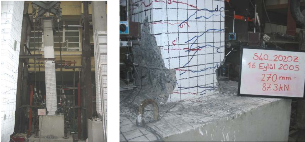
Şekil 4.63 : S40_2020Z numunesine ait hasar fotoğrafları.
