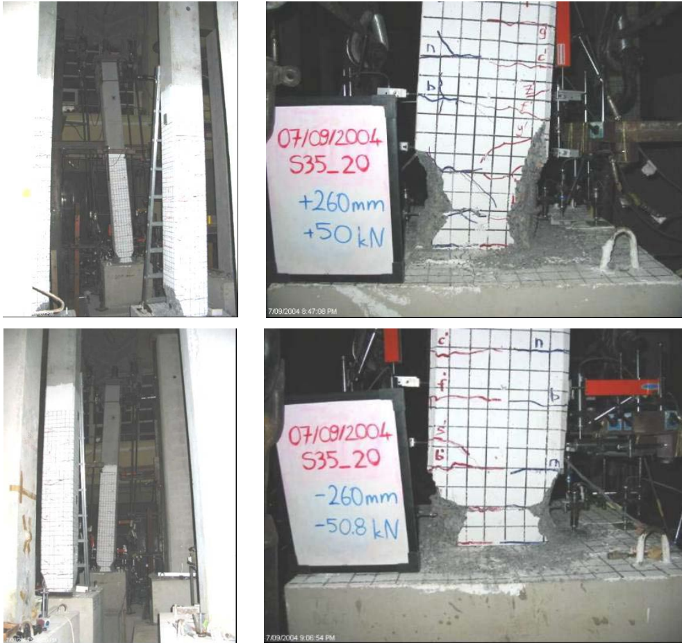
Şekil 4.41 : S35_20 numunesine ait hasar fotoğrafları.
