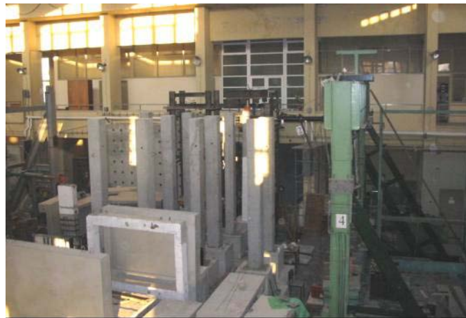
Şekil 4.3 : Üretimi tamamlanan prefabrike kolon numuneler.
