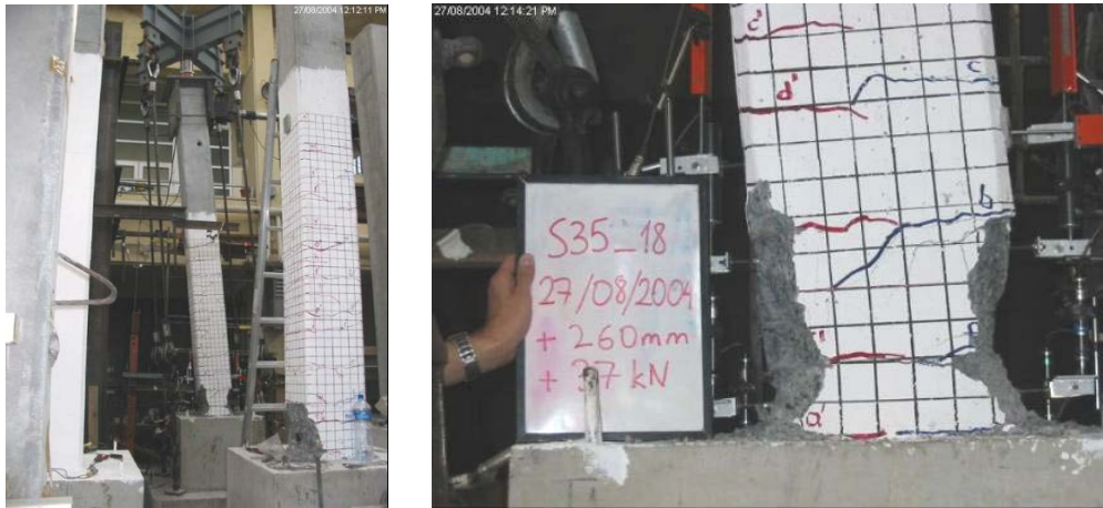
Şekil 4.36 : S35_18 numunesine ait hasar fotoğrafları.
