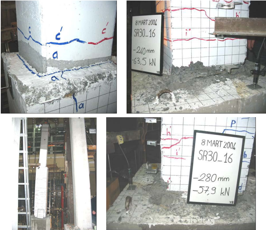
Şekil 4.87 : SR30_16 numunesine ait hasar fotoğrafları.
