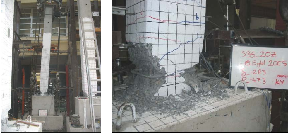
Şekil 4.46 : S35_20Z numunesine ait hasar fotoğrafları.
