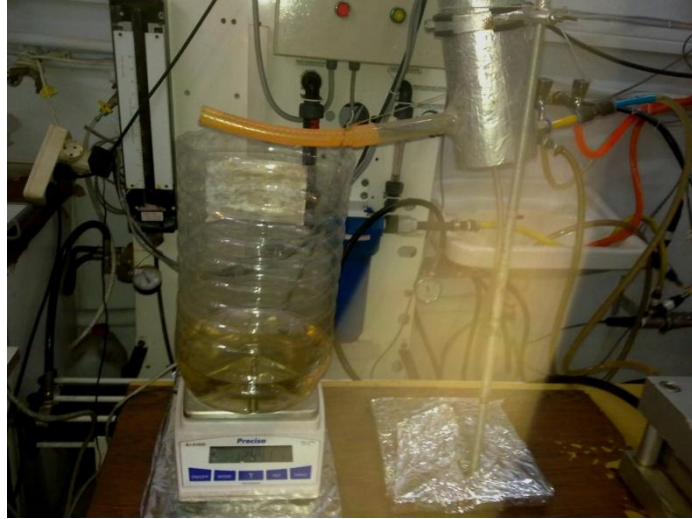
Şekil 3.10: Bilgisayara bağlı terazi ve süzüntü kabının görüntüsü.
