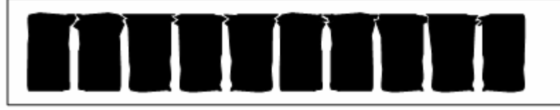
Şekil 2.11: Asimetrik membranların yapısı.
