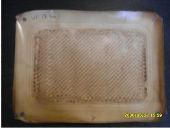
Şekil 4.6: Maya seperasyon prosesi atıksuyunun UC100T membranı ile arıtılması sonucu oluşan kek tabakasının görünümü.
