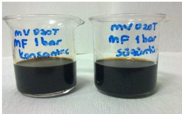
Şekil 4.56: Maya seperasyon prosesi atıksuyunun MV020T membranı ile arıtımı ile elde edilen konsantre ve süzüntünün görünümü.
