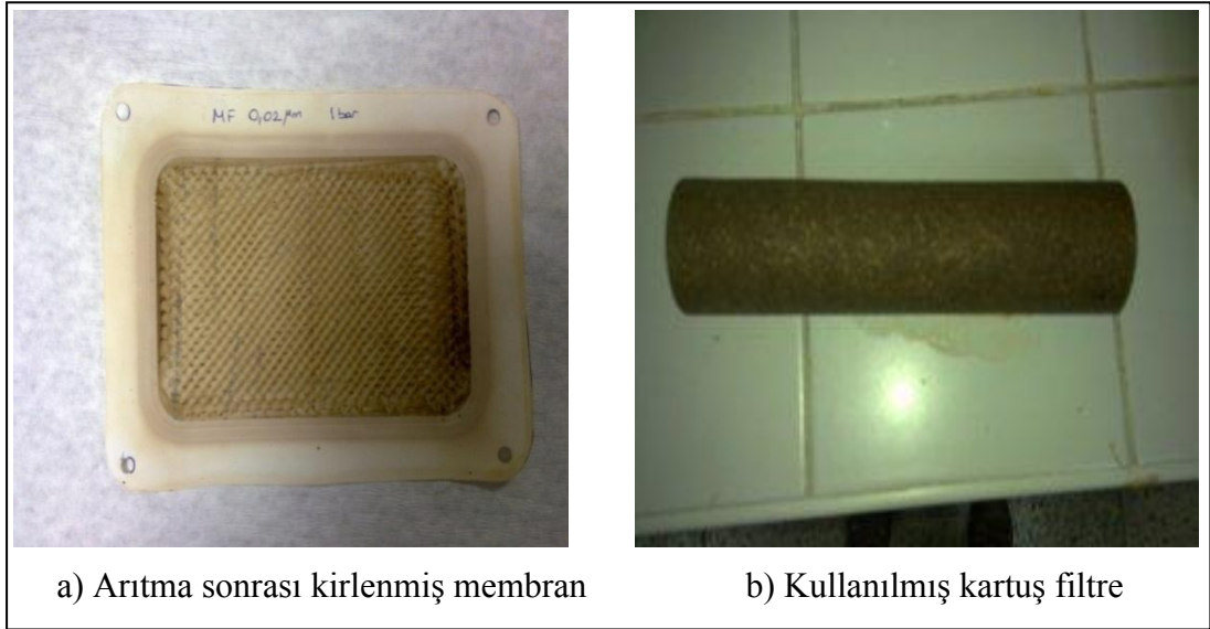
Şekil 3.5: Arıtma sonrası kirlenmiş bir membran (a) ve kartuş filtre (b) görünümü.
