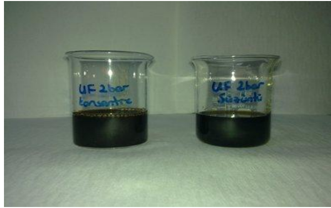
Şekil 4.27: Maya seperasyon prosesi atıksuyunun UC100T membranı ile arıtımı ile elde edilen konsantre ve süzüntünün görünümü.
