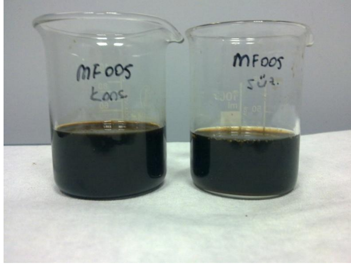
Şekil 4.85: Maya seperasyon prosesi atıksuyunun MP005 membranı ile ön arıtım sonrası elde edilen süzöntü ve konsantre akımının görüntüsü.
