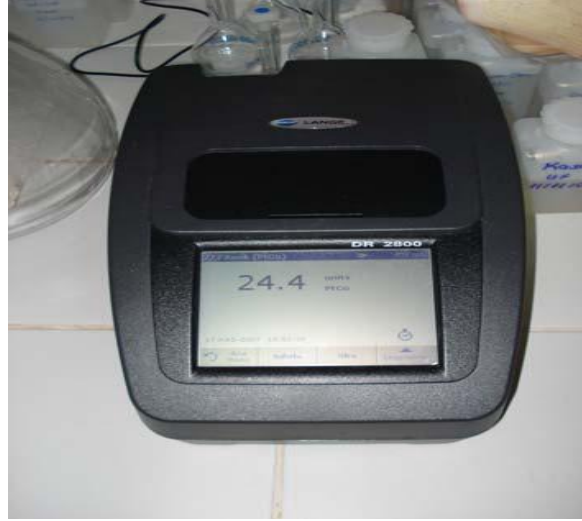
Şekil 3.12: Hach marka, DR 2800 spektrofotometre.
