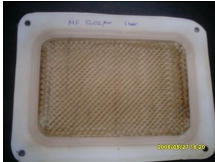
Şekil 4.34: Maya seperasyon prosesi atıksuyunun MV020T membranı ile arıtımı sonucu oluşan kek tabakasının görünümü.
