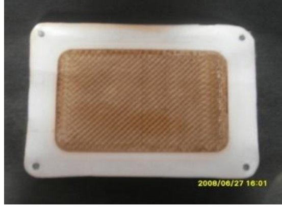
Şekil 4.63: Maya seperasyon prosesi atıksuyunun MP005 membranıyla arıtımı sonucu oluşan kek tabakasının görünümü.
