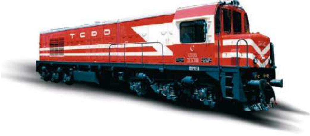
DE24000 tipi anahat lokomotifi genel görünüşü
