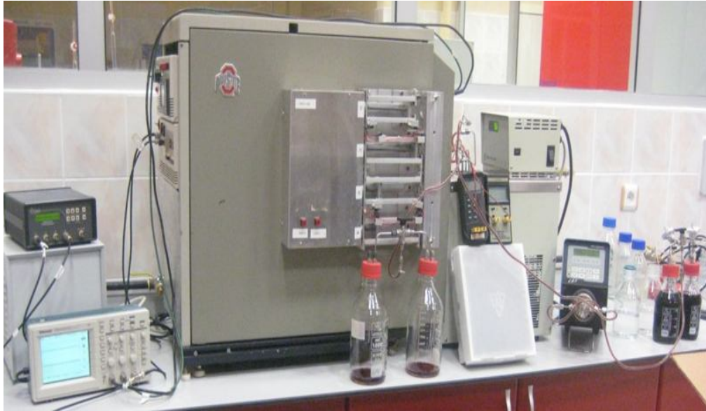
Şekil 3.1. Deneylerde kullanılan laboratuvar ölçekli PEF sistemi.
