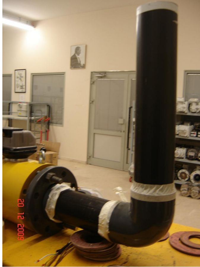
Şekil 7.14 : Sayaç girişe 3D uzaklıkta 90° açılı dirsek testi
