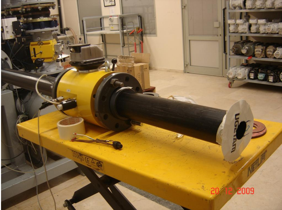
Şekil 7.19 : Sayaç girişinde 5D (45 mm) uzaklıkta orifis uygulaması
