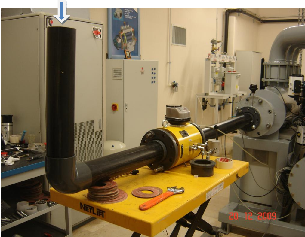
Şekil 7.9 : Test 3 Düzenegi, sayaç girişinde 5D uzaklıkta 90° açılı dirseklili uygulama
