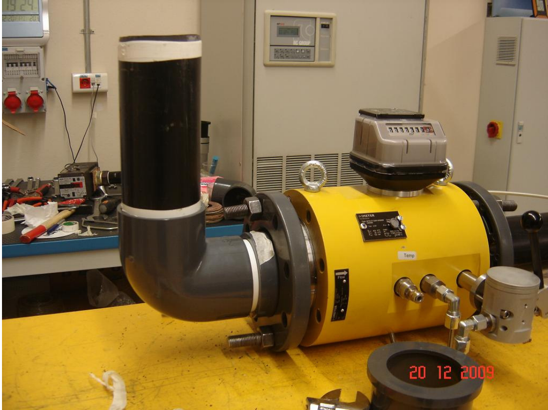
Şekil 7.21 : Test 8 düzeneği, sayaç girişine 1xD uzaklıkta 90° açılı dirsek testi
