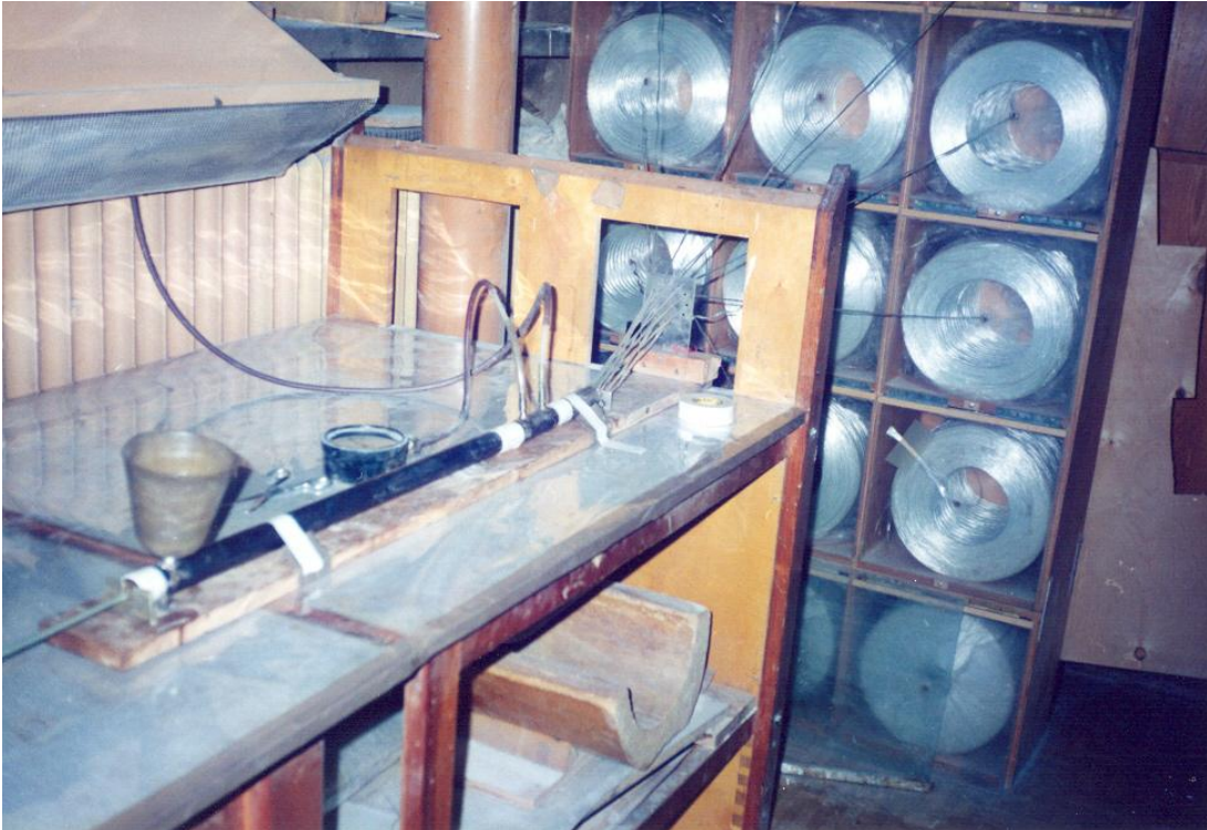
Şekil 4.3: Varşova Politeknik Üniversitesi Havacılık Fakültesi planör imalat atölyesinde kullanılan vakumlu fiber hazırlama sistemi
