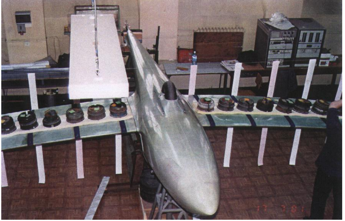
Şekil 4.2.a: Planör imalatı sonrası tasarım yük katsayılarına uygun statik test
