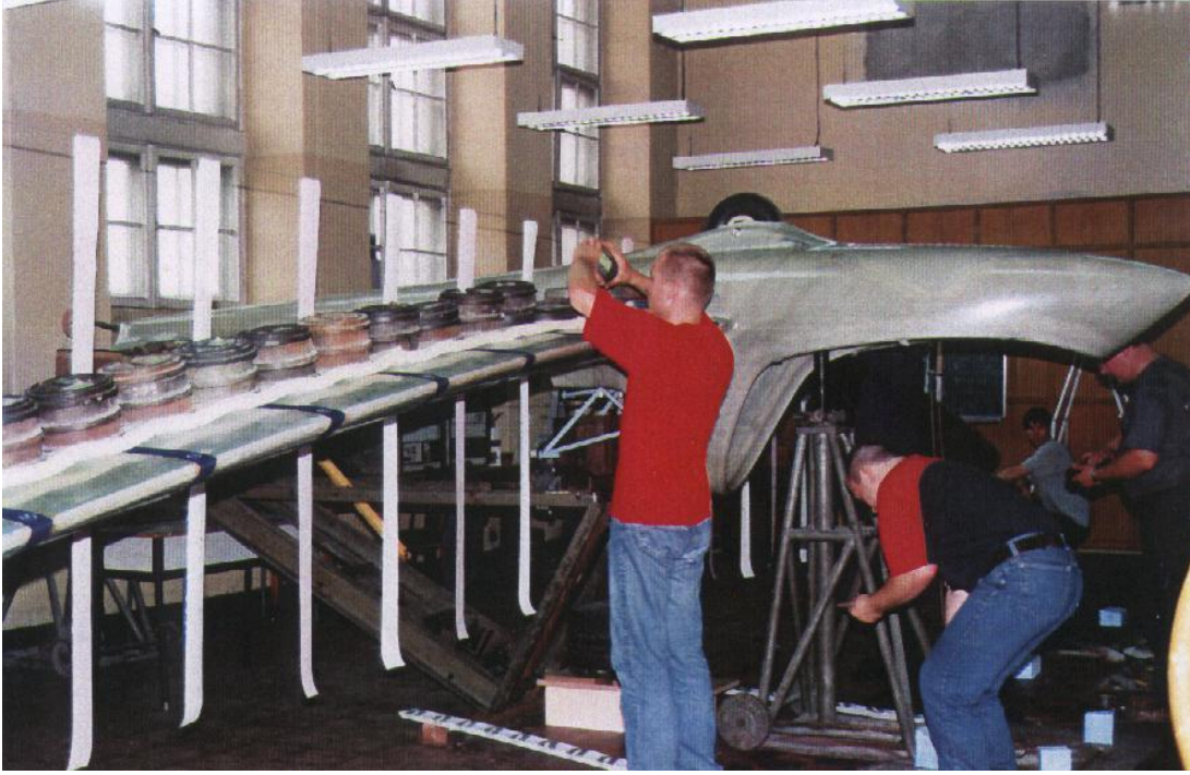
Şekil 4.2.c: Planör imalatı sonrası tasarım yük katsayılarına uygun statik test
