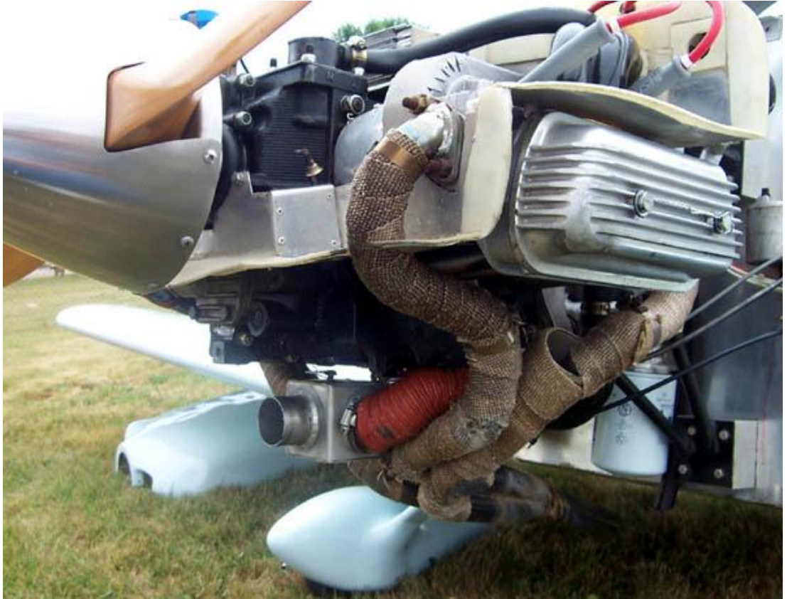
Şekil 5.3: Bir VW motorunun uçak motoruna dönüştürüldükten sonra bir uçağa takılmış hali
