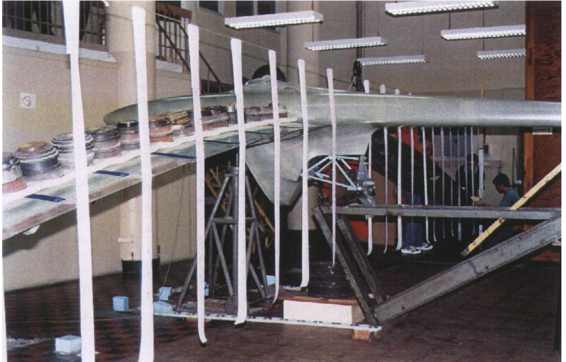
Şekil 4.2.b: Planör imalatı sonrası tasarım yük katsayılarına uygun statik test
