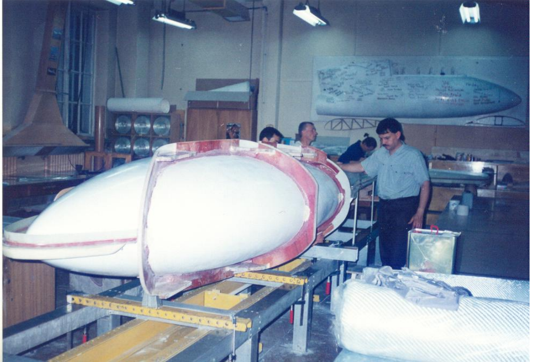
Şekil 4.4.b: Varşova Politeknik Üniversitesi Havacılık Fakültesi planör imalat atölyesinde pw-6 motorlu planörü üzerinde çalışma (Temmuz 1997)
