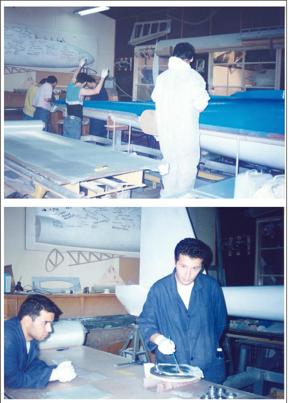
Şekil 3.15: Varşova Politeknik Üniversitesi Havacılık Fakültesi atölyesinde PW-6 çift kişilik motorlu planör kalıpları üzerinde yapılan çalışmalar
