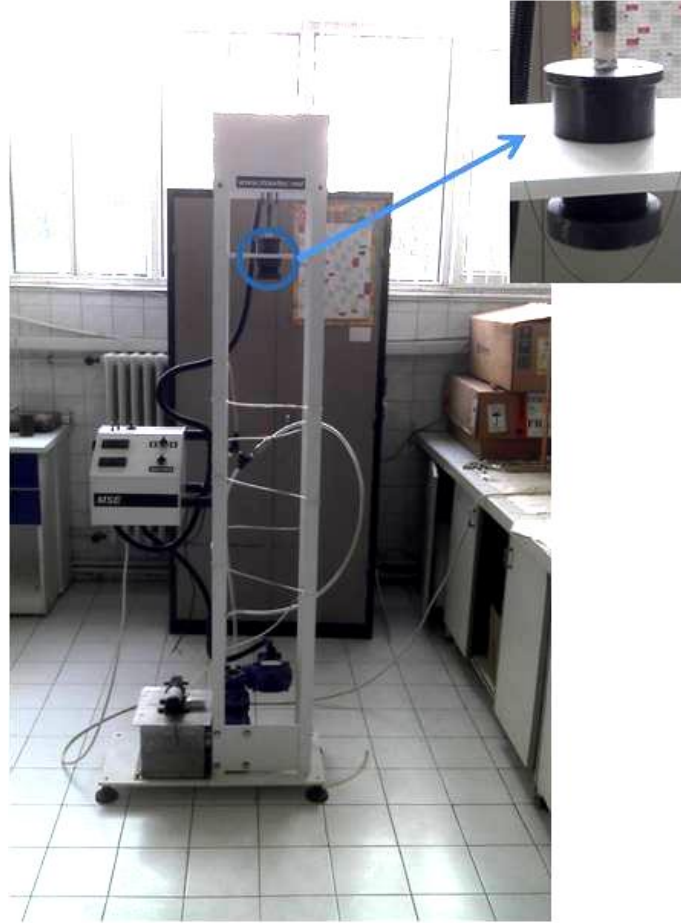
Şekil 3.4. Fiber çekme makinesi[GYTE, Malzeme Bilimi ve Mühendisliği, Elektronik Malzemeler Araştırma Laboratuvarı].
