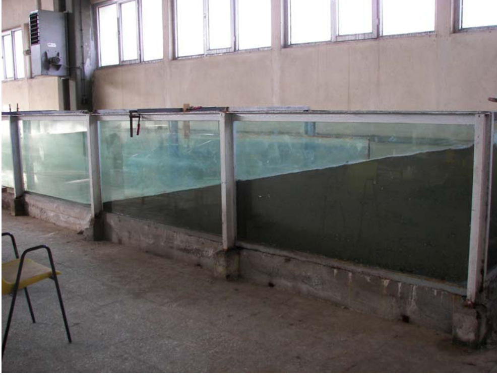
Şekil 5.9: Kanalda oluşturulan 1/5 eğimli şev.
