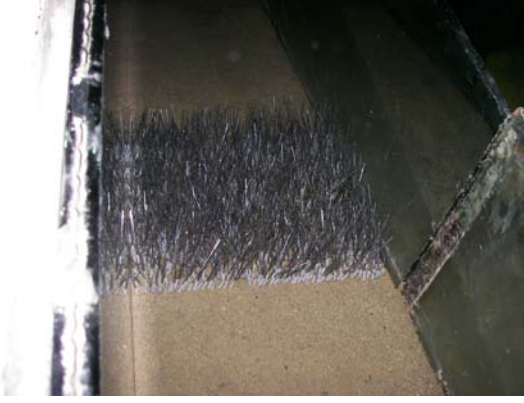
Şekil 5.7: Model posidonia 'ların kanala yerleştirilmesi.
