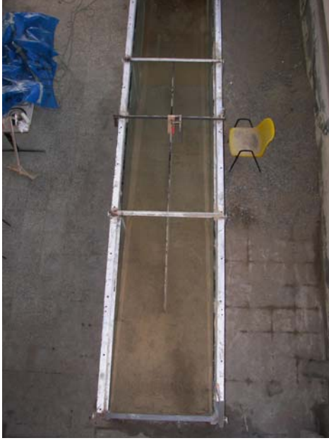
Şekil 5.6: Kanalin cam levha vasıtası ile ikiye bölünmesi.
