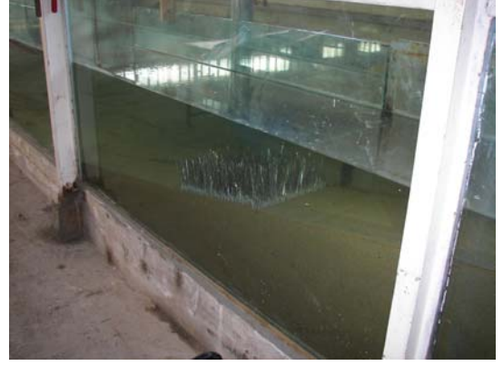
Şekil 5.7: Model posidonia 'ların kanala yerleştirilmesi.
