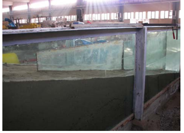
Şekil 5.6: Kanalin cam levha vasıtası ile ikiye bölünmesi.
