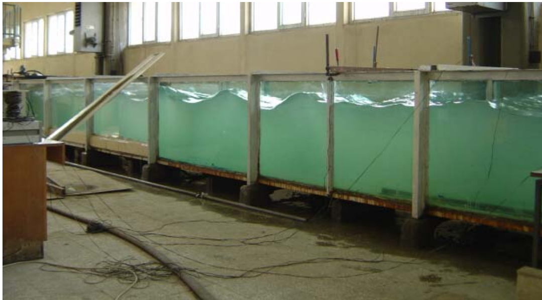
Şekil 5.5: Model deneylerinde kullanılan dalga kanalının fotoğrafı.
