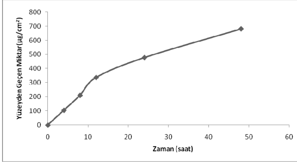
Şekil 22: İbuprofenin iki selofan arası 2 mg/ml ÇTKNT ve %1 BSA ve Kolesterol dispersiyonu içeren membrandan yapılan geçiş deneyinin profili
