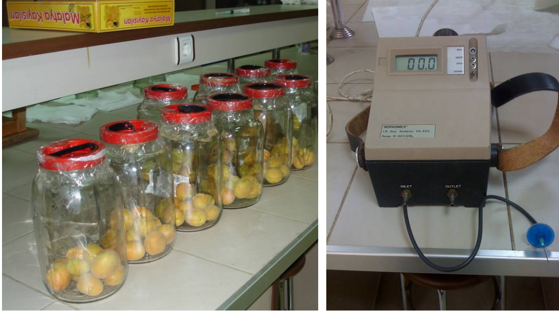
Şekil 3.7 Kayısıların solunum kavanozlarına alınması
