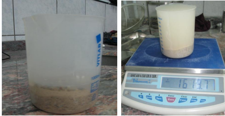
Şekil 4.7 İnce agreganın özgül ağırlığının bulunması
