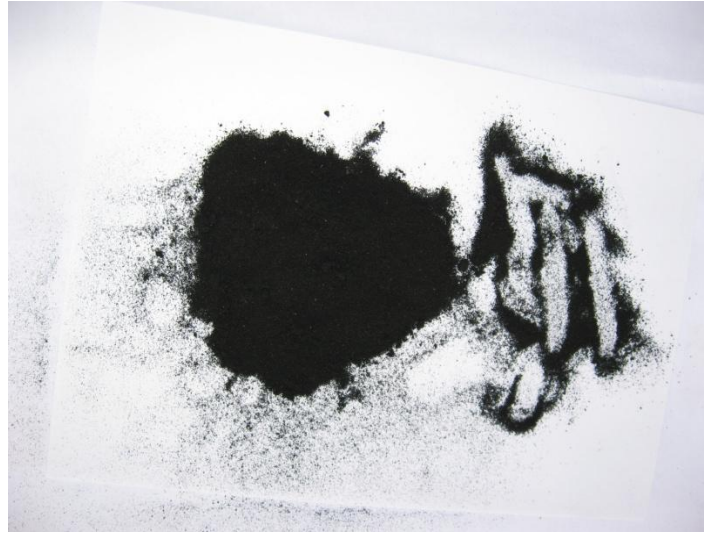
Şekil 3.11. Yüksek Basınç Altında Özel Olarak Öğütülmüş Otomobil Lastiği
