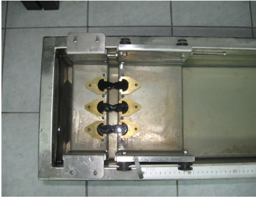
Şekil 4.21 Düktilite deney aşamaları (a)
