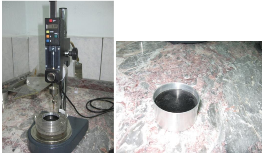
a b Şekil 4.16 Penetrasyon cihazı (a) ve numune (b)
