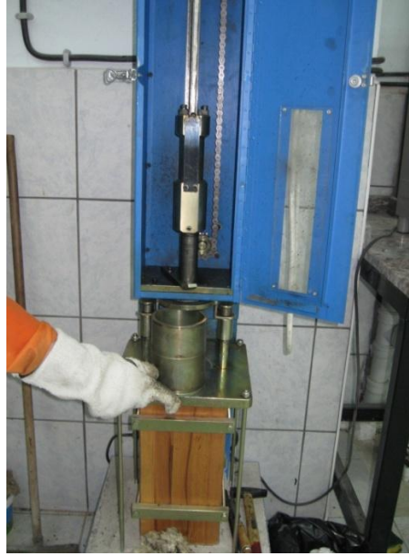
Şekil 4.45 Karışımın Marshall tokmağında sıkıştırılması
