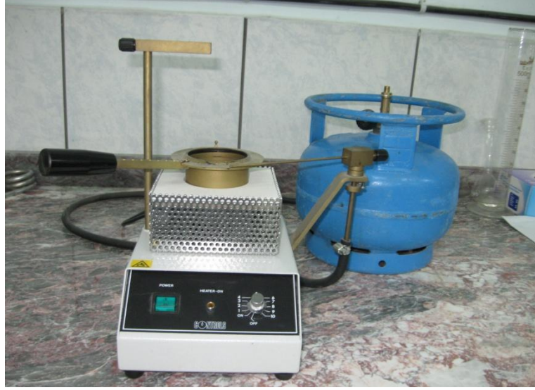
Şekil 4.25 Parlama noktası deney düzeneği
