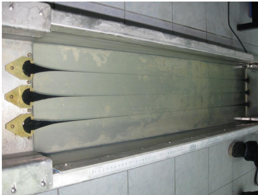
Şekil 4.23 Düktilite deney aşamaları (c)
