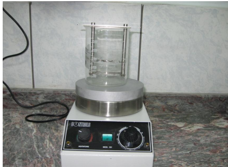
Şekil4.13 Yumuşama noktası deney düzeneği
