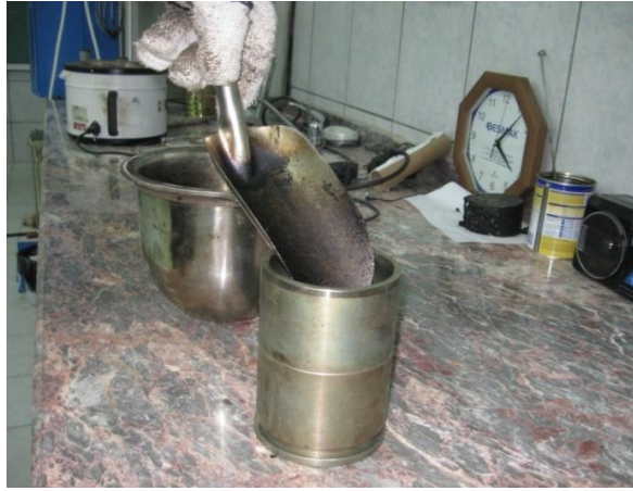
Şekil 4.43 Karışımın numune kalıbına konulması
