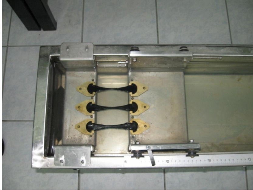
Şekil 4.22 Düktilite deney aşamaları (b)
