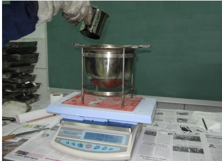
Şekil 4.40 Agrega karışımına bitüm eklenmesi
