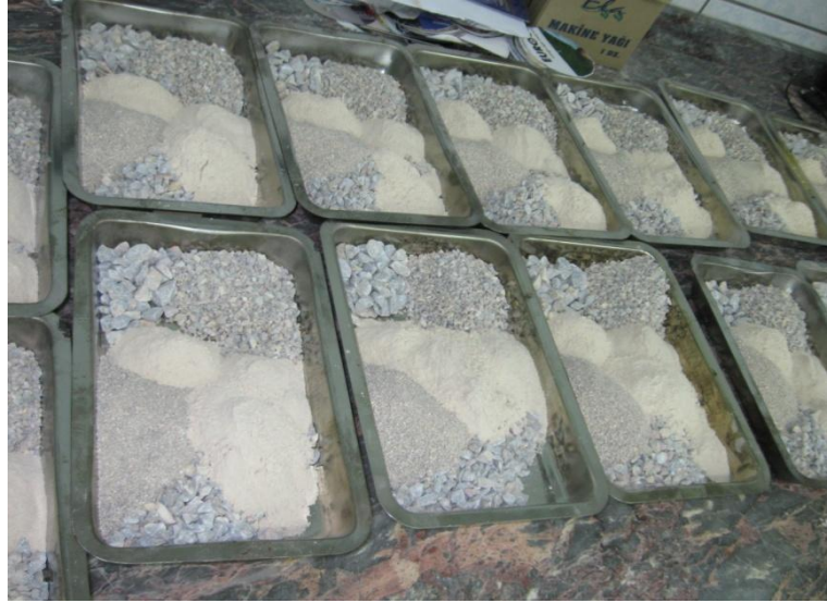
Şekil 4.39 Gradasyonu ayarlanmış agrega numuneleri
