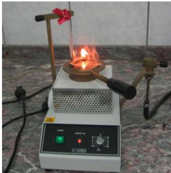
Şekil 4.27 Numunenin parladığı an
