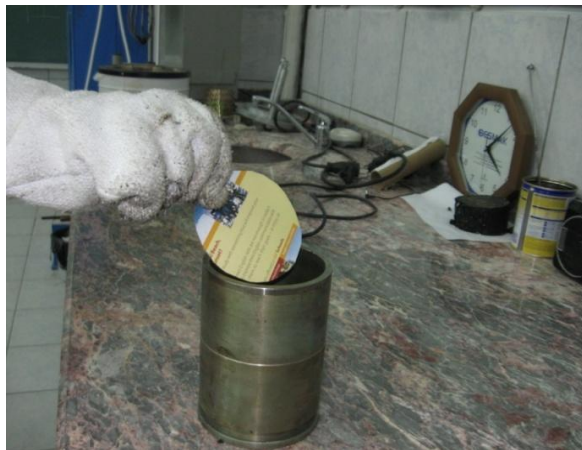
Şekil 4.42 Numune kalıbının tabanına konulan yağlı kağıt
