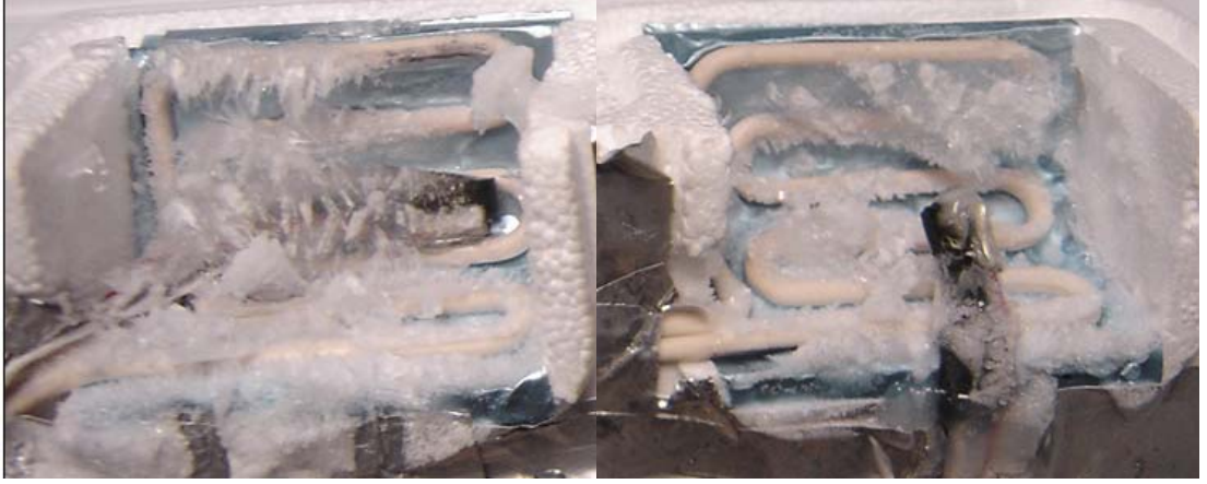
Şekil 1.9 : Isıtıcıların çalışmadığı zaman oluşan buzlanma
