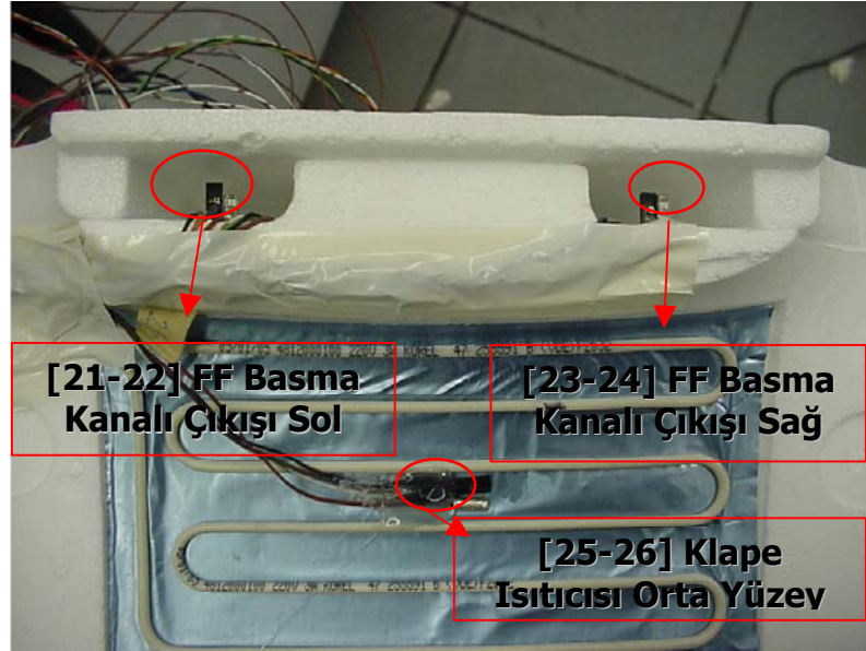
Şekil 3.7 : Basma kanalı çıkışına ve termostat kutusu alt yüzeye yerleştirilen sensörler (FF: taze besin (Fresh Food) bölmesi.)
