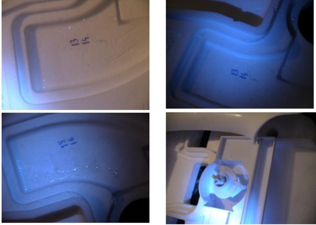
Şekil 3.20 : Termostat kutusu içinde oluşan terleme
