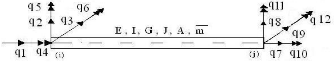
Şekil 3.1 Üç boyutlu çerçeve elemanı pozitif uç serbestlikleri
