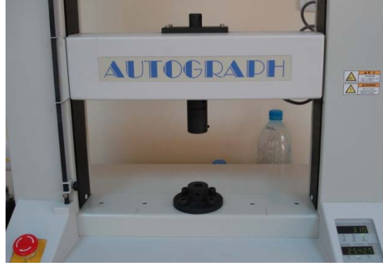
Resim 31: Shimadzu KgN50 üniversal test cihazı
