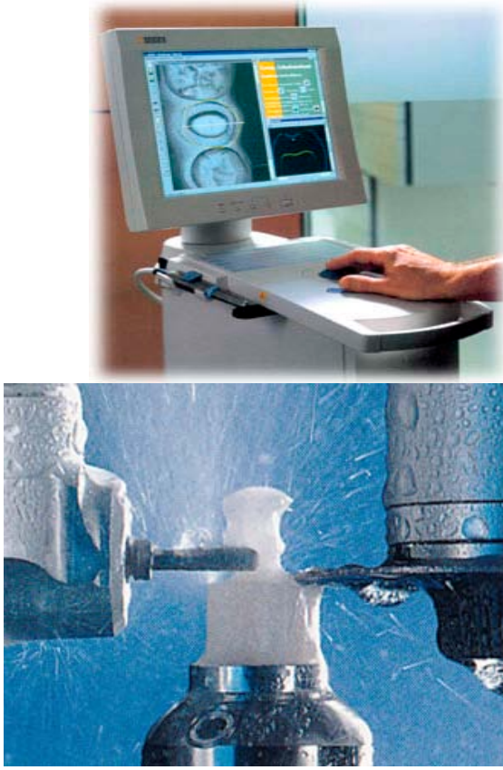
Resim 10: Cerec sistemiyle restorasyon tasarımı ve şekillendirilmesi (181)
