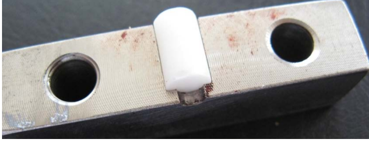
Resim 27: Zirkonya altyapının metal kalıp içindeki görüntüsü
