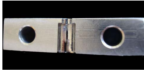
Resim 26: Üstyapı seramiğinin yüklenmesinde kullanılan metal kalıp
