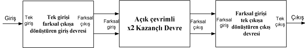
Şekil 3.33 : Ölçüm Devresi Blok Diyagramı
