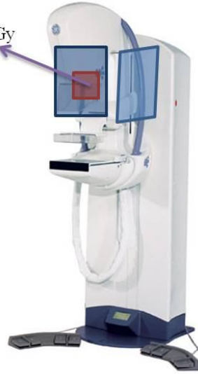
Şekil 3.4. Sızıntı radyasyon testi deney düzeneği
