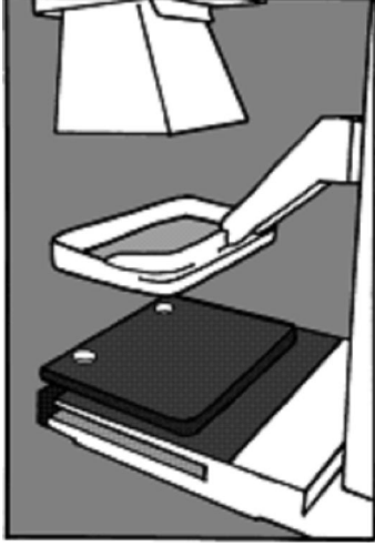
Şekil 3.1. X-Işın alanıyla ışık alanının uyumluluğu testi deney düzeneği
