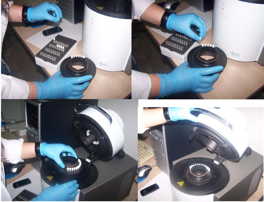
Şekil III.8 Cam kapillerlerin qPCR cihazına yerleştirilme işlemi
