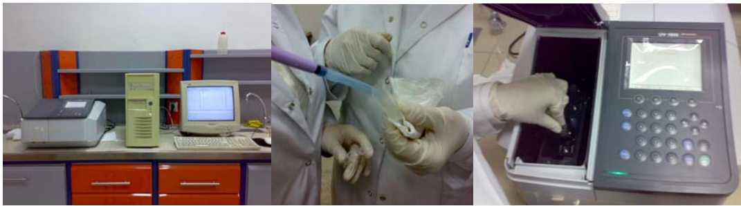
Şekil III.2 DNA'nın miktar ve saflığının spektrofotometrik olarak belirlenmesi
