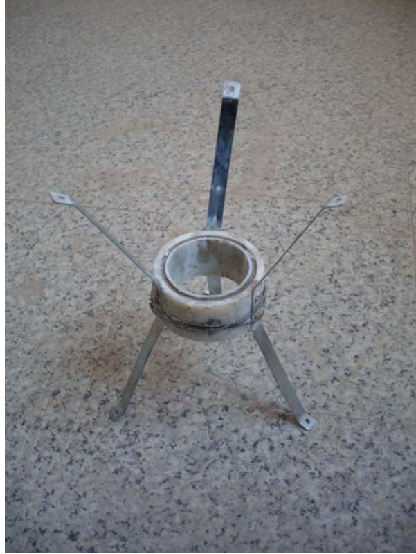
Şekil 6.29 : Manyetik oturma kolonu reflektörü (spider magnet)
