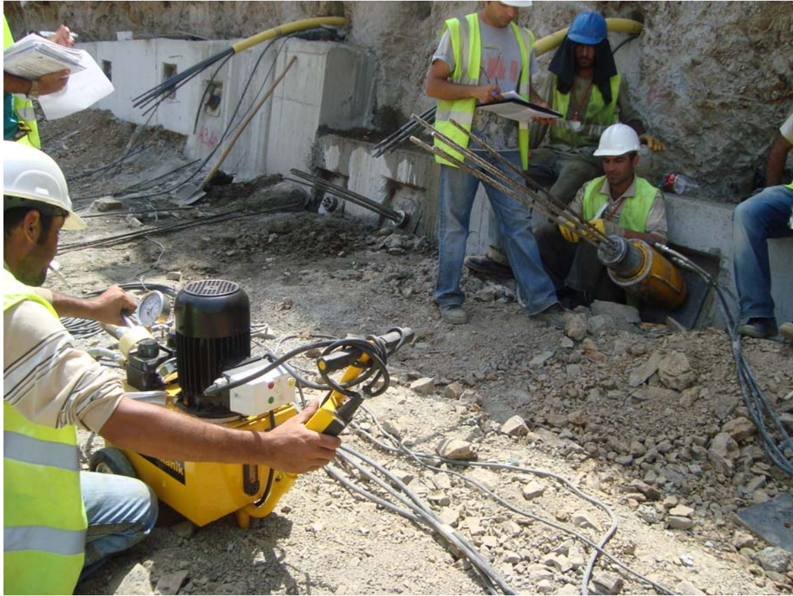
Şekil 5.23 : Ankraj yük deneyi
