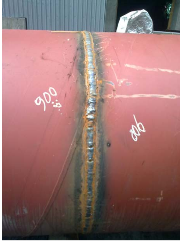
Şekil 5.38 : Alın kaynağı ile birleştirilmiş boru parçaları
