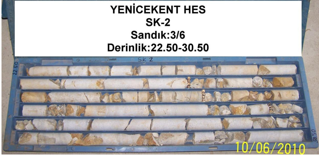
EK-2.7 SK-2 Nolu Sondajın 3 nolu karot sandığı
