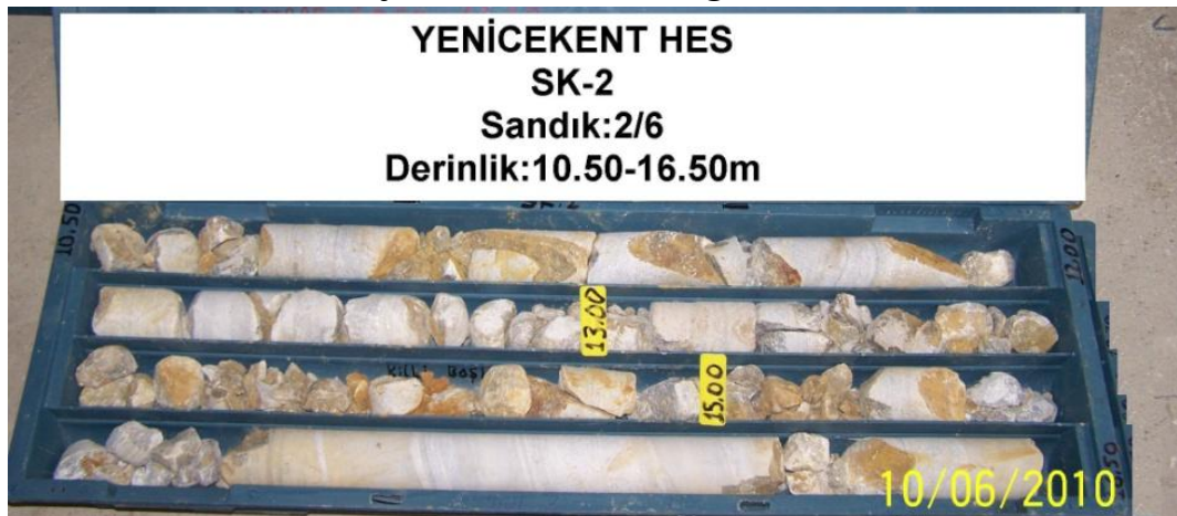
EK-2.6 SK-2 Nolu Sondajın 2 nolu karot sandığı
