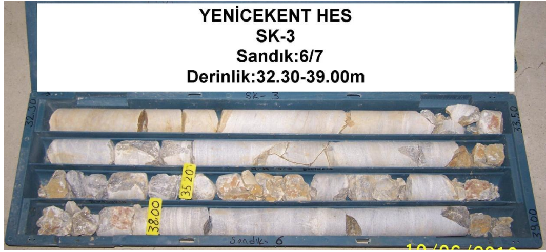
EK-2.16 SK-3 Nolu Sondajın 6 nolu karot sandığı
