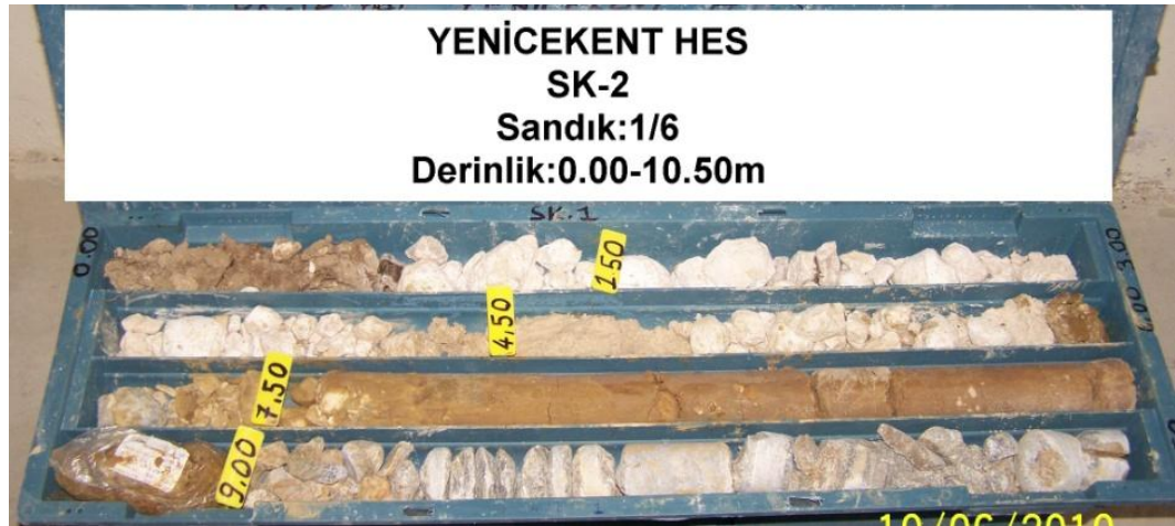
EK-2.5 SK-2 Nolu Sondajın 1 nolu karot sandığı
