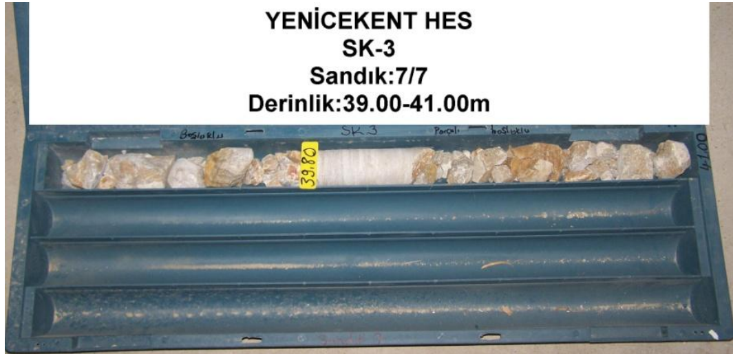
EK-2.17 SK-3 Nolu Sondajın 7 nolu karot sandığı
