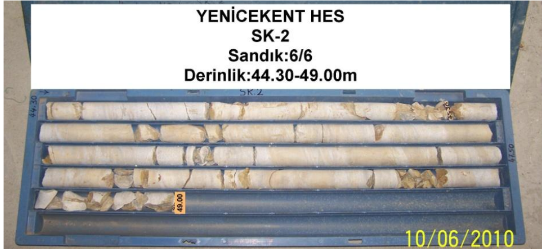
EK-2.10 SK-2 Nolu Sondajın 6 nolu karot sandığı
