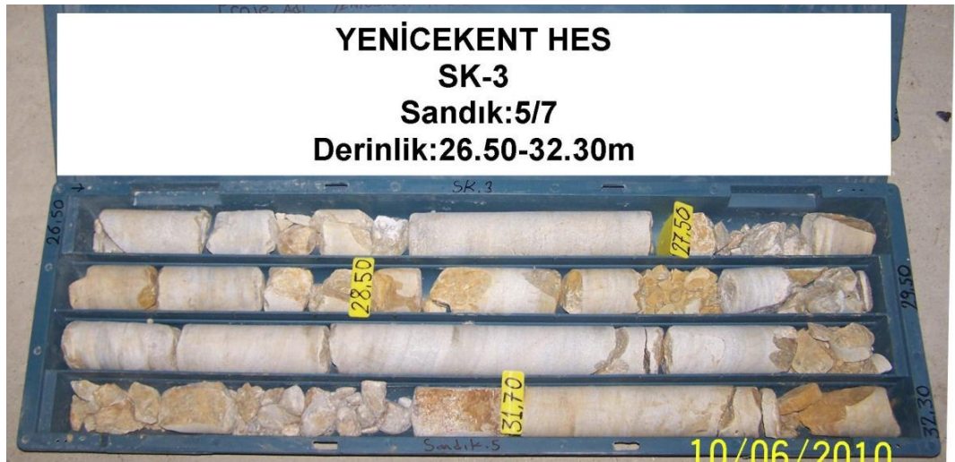
EK-2.15 SK-3 Nolu Sondajın 5 nolu karot sandığı
