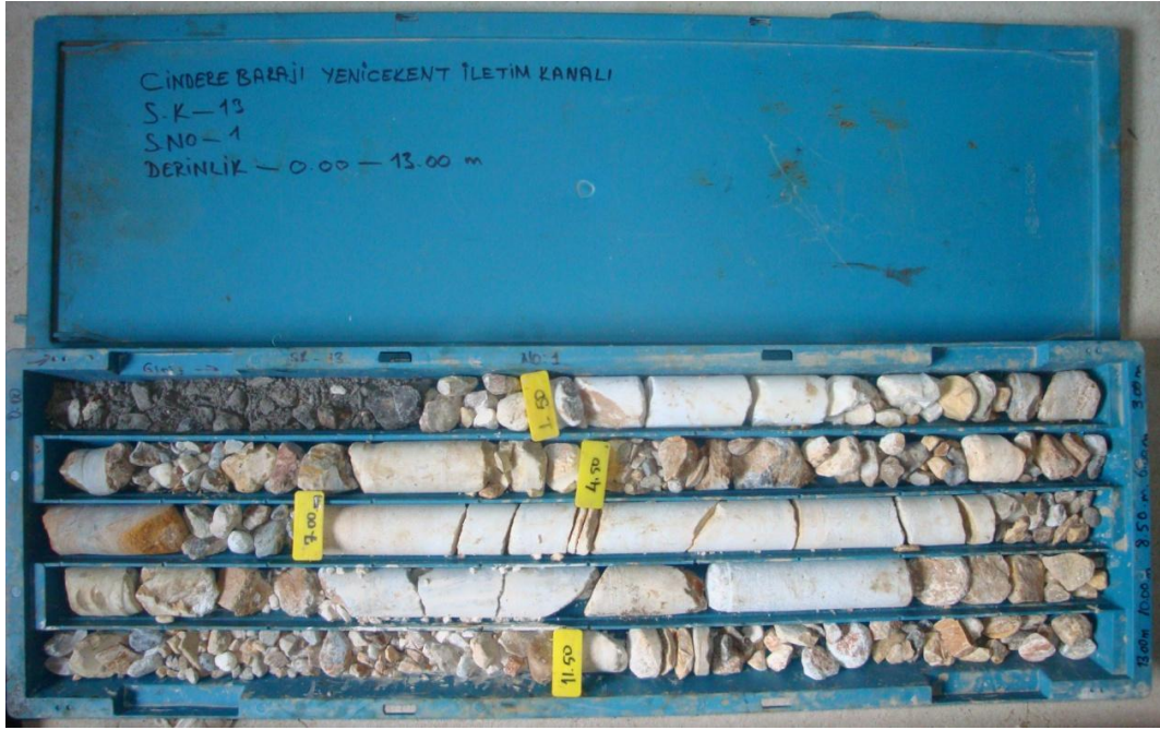
EK-2.18 SK-13 Nolu Sondajın 1 nolu karot sandığı
