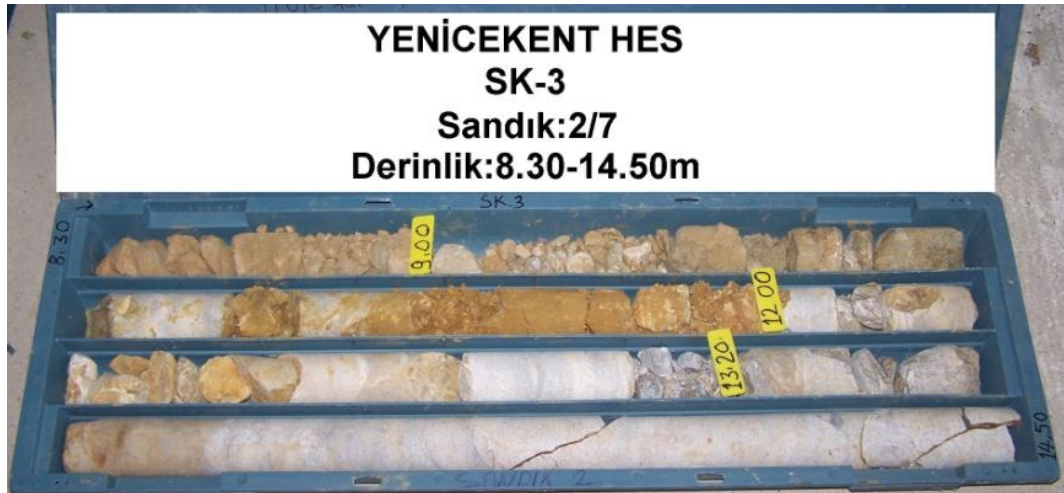
EK-2.12 SK-3 Nolu Sondajın 2 nolu karot sandığı
