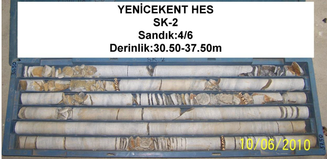
EK-2.8 SK-2 Nolu Sondajın 4 nolu karot sandığı
