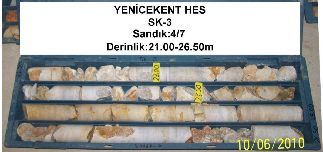
EK-2.14 SK-3 Nolu Sondajın 4 nolu karot sandığı
