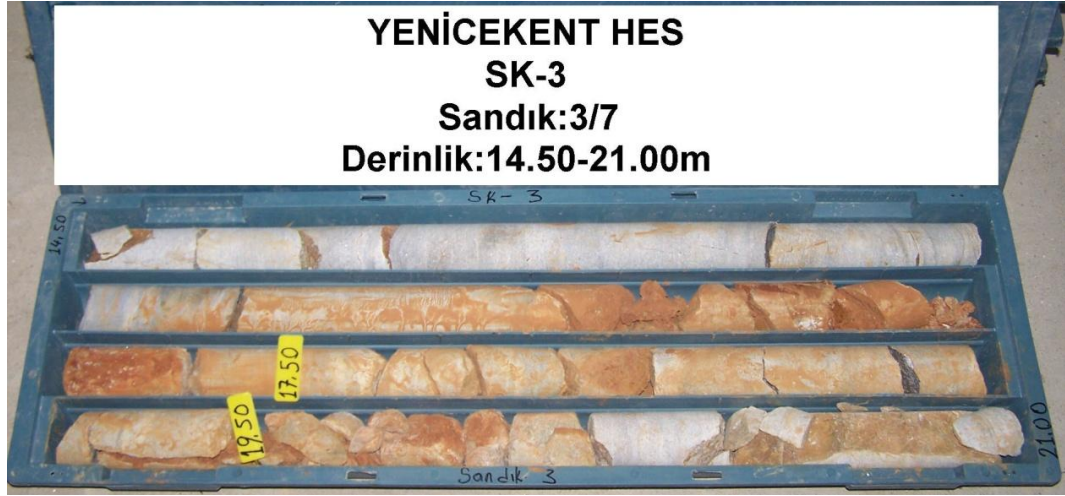
EK-2.13 SK-3 Nolu Sondajın 3 nolu karot sandığı
