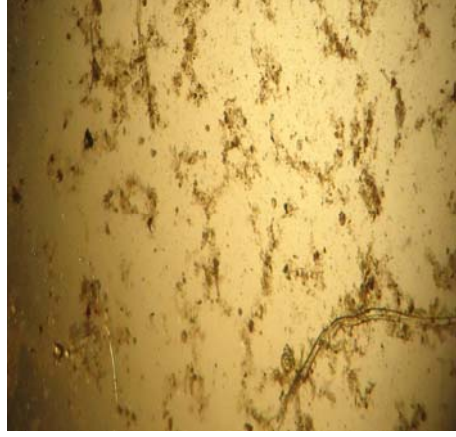
Şekil 4.61. 30dk %100 amplitude ultrasona tabi tutulmuş çamurun flok yapısı (40X büyütme)
