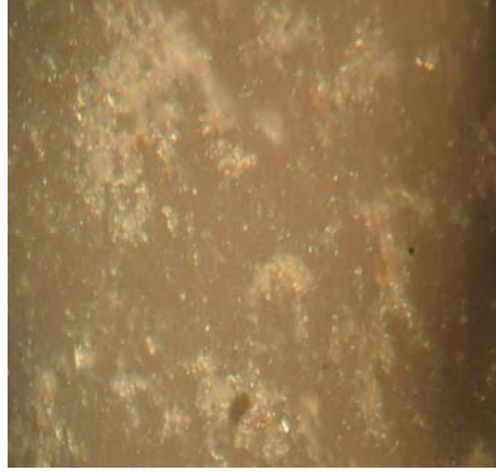
Şekil 4.61. 30dk %100 amplitude ultrasona tabi tutulmuş çamurun flok yapısı (40X büyütme)
