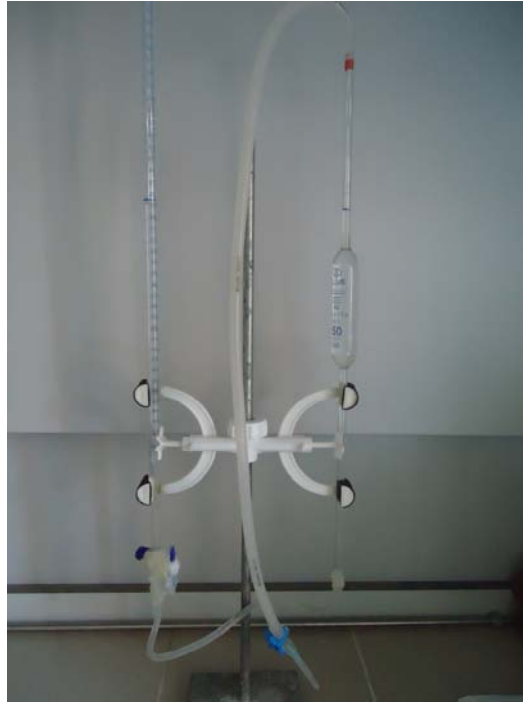
Şekil 3.2. Hacim deplasman yöntemi amacıyla kurulan gaz ölçüm düzeneği
