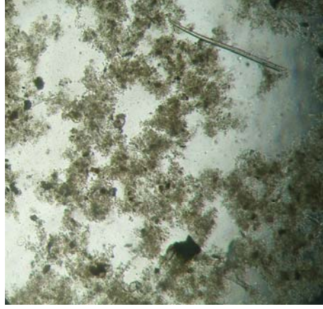
Şekil 4.16. 5dk %20 amplitude ultrasona tabi tutulmuş çamurun flok yapısı (100X büyütme)
