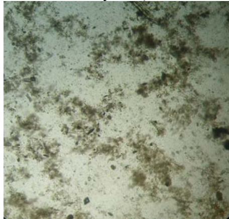
Şekil 4.18. 30dk %20 amplitude ultrasona tabi tutulmuş çamurun flok yapısı (100X büyütme)
