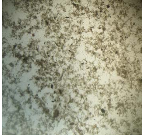
Şekil 4.17. 30dk %20 amplitude ultrasona tabi tutulmuş çamurun flok yapısı (40X büyütme)
