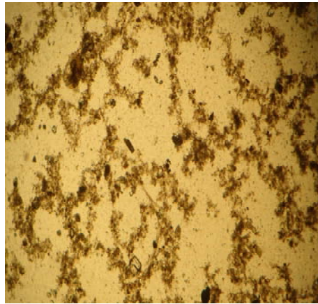
Şekil 4.63. 15dk %60 amplitude ultrasona tabi tutulmuş çamurun flok yapısı (40X büyütme)
