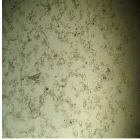
Şekil 4.59. 5dk %100 amplitude ultrasona tabi tutulmuş çamurun flok yapısı (40X büyütme)
