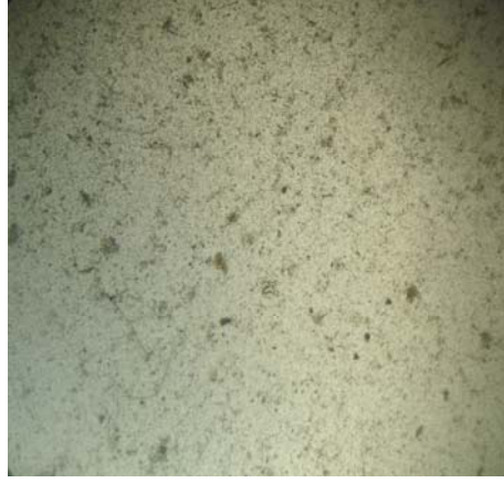
Şekil 4.21. 30dk %100 amplitude ultrasona tabi tutulmuş çamurun flok yapısı (40X büyütme)
