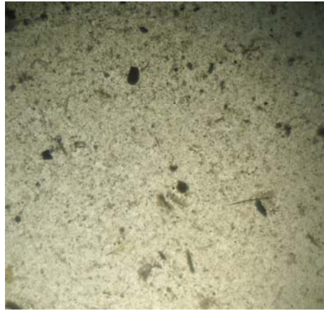
Şekil 4.23. 15dk %60 amplitude ultrasona tabi tutulmuş çamurun flok yapısı (40X büyütme)
