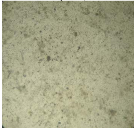
Şekil 4.22. 30dk %100 amplitude ultrasona tabi tutulmuş çamurun flok yapısı (100X büyütme)
