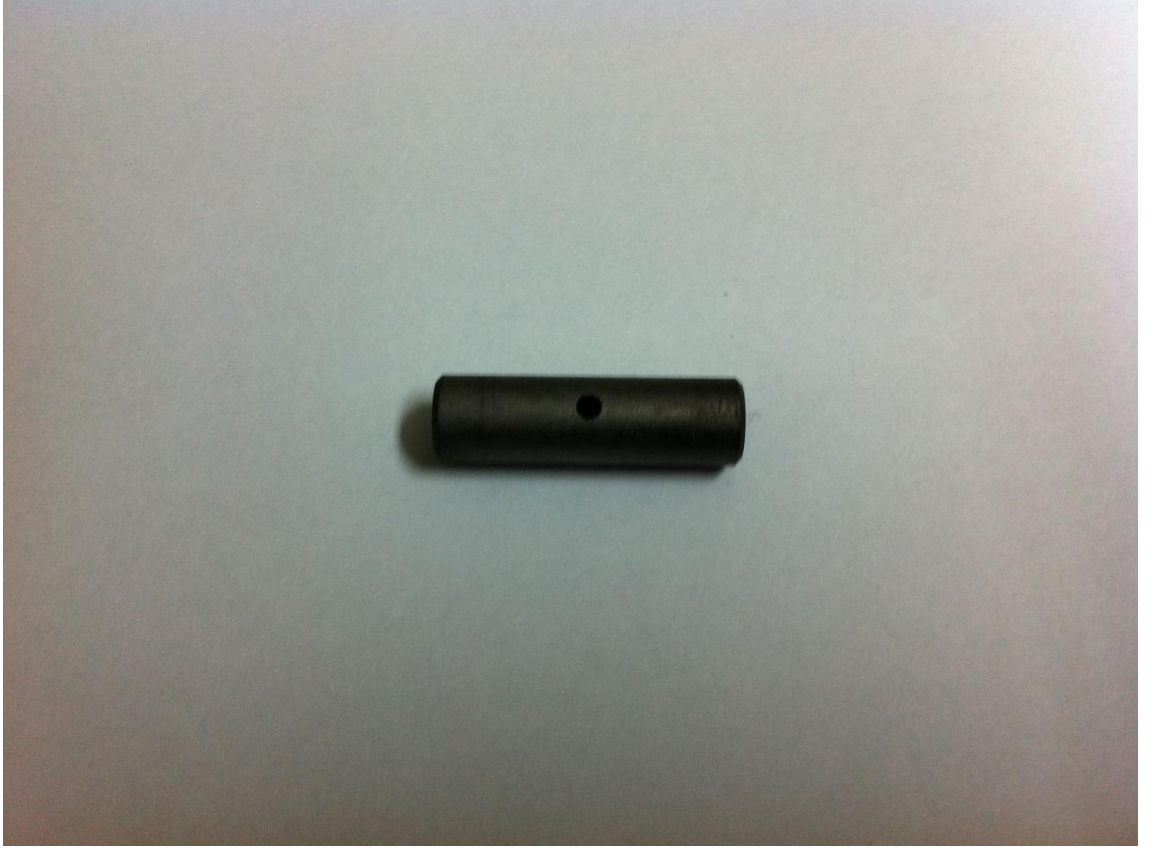
Şekil 3.4 ETAAS yönteminde kullanılan grafit küvet
