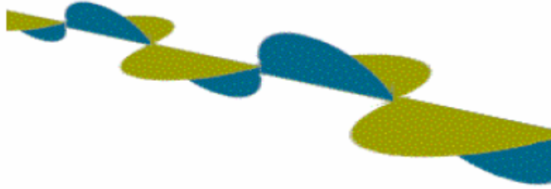
Şekil 1. Elektromanyetik dalga yayılımı (açık renk manyetik alanı ve yönü, koyu renk elektrik alan ve yönü)
