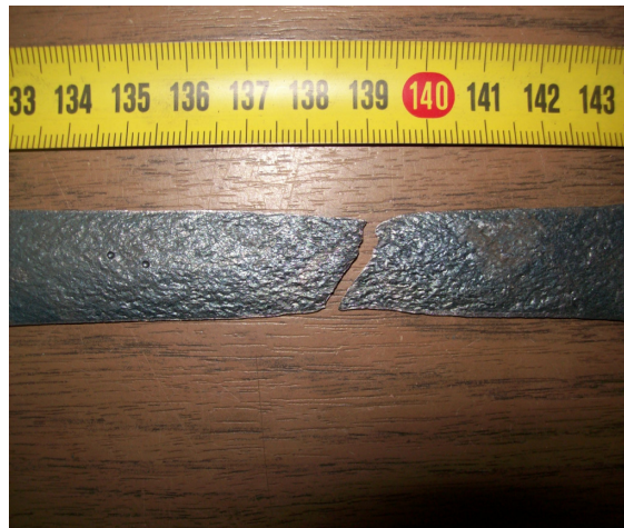
Şekil 5.2 Belirli ön deformasyon ve tavlama işlemine tabi tutulmuş bazı numunelerden gözlenen "portakal kabuğu" oluşumu
