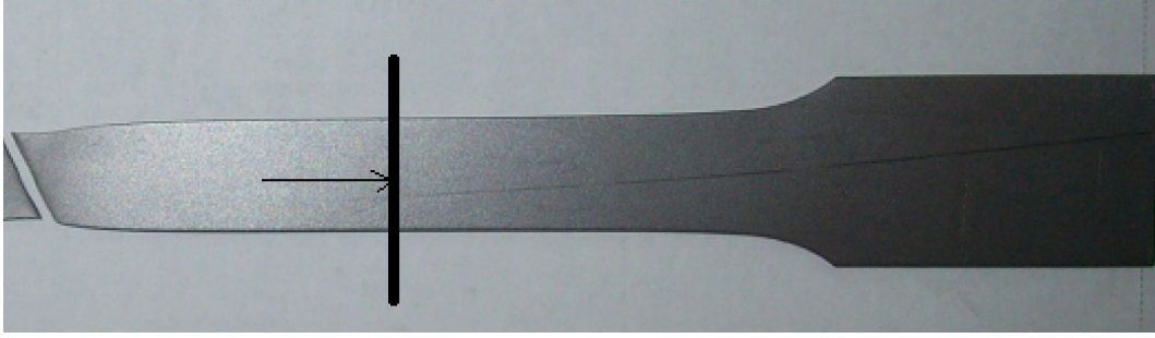
Şekil 4.10 Kopan çekme test çubuğu üzerinde mikropyapısal incelemelerin yapıldığı bölge.
