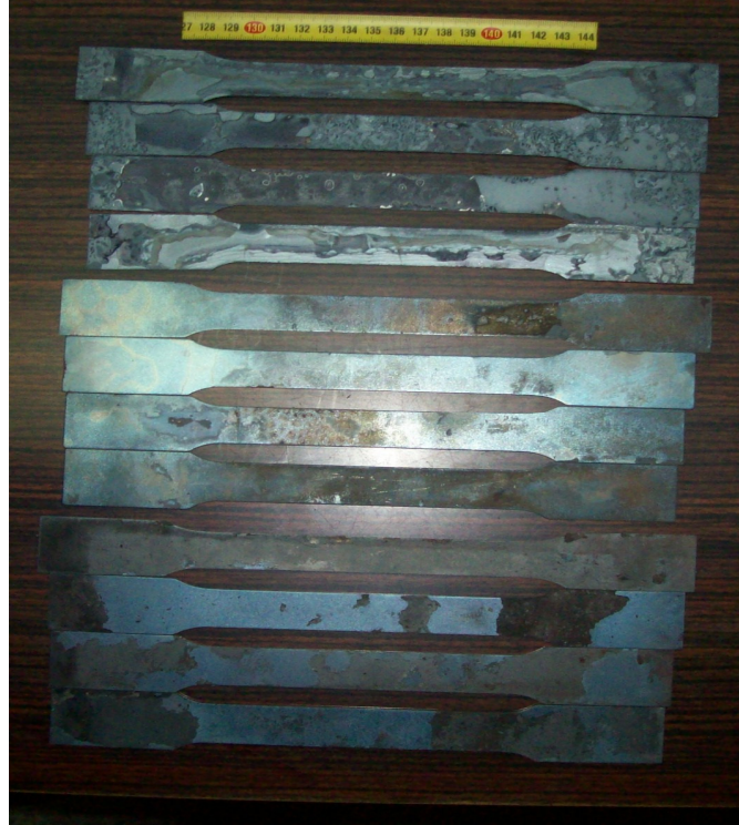
Şekil 4.9 Tavllanmış numunelerden çekme testi öncesi görüntüler.
