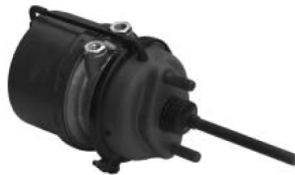
Şekil 2.9 Yaylı fren silindiri ( Çiftli körük )
