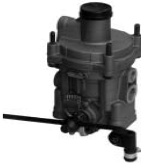
Şekil 2.6 Fren kuvvet ayarlayıcı (yüke duyarlı mekanik kuvvet algılayıcı)
