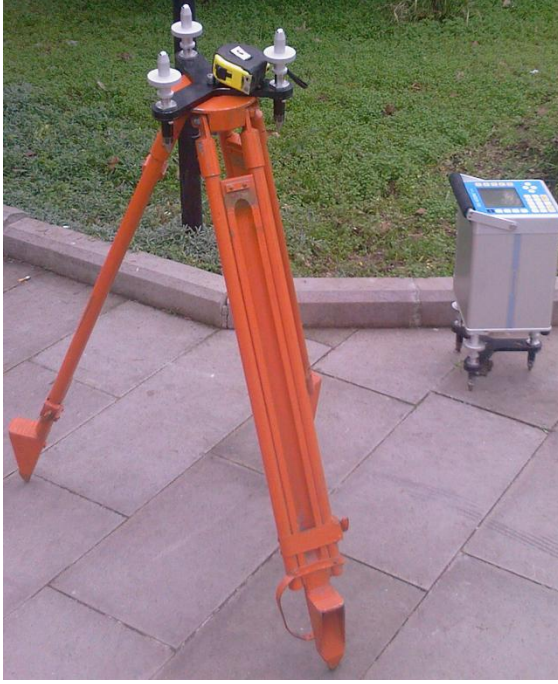
Şekil 3.2. Modifiye edilen üç ayaklı topograf sehpa, CG-5 mikrogravimetri, şerit metre ve CG-5 düzeç sehpa.
