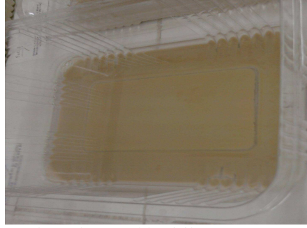
Resim 4.1. Demir(3) klorür koagülantıyla gerçekleştirilen arıtma sonucu çıkış atıksuyundan görünüm
