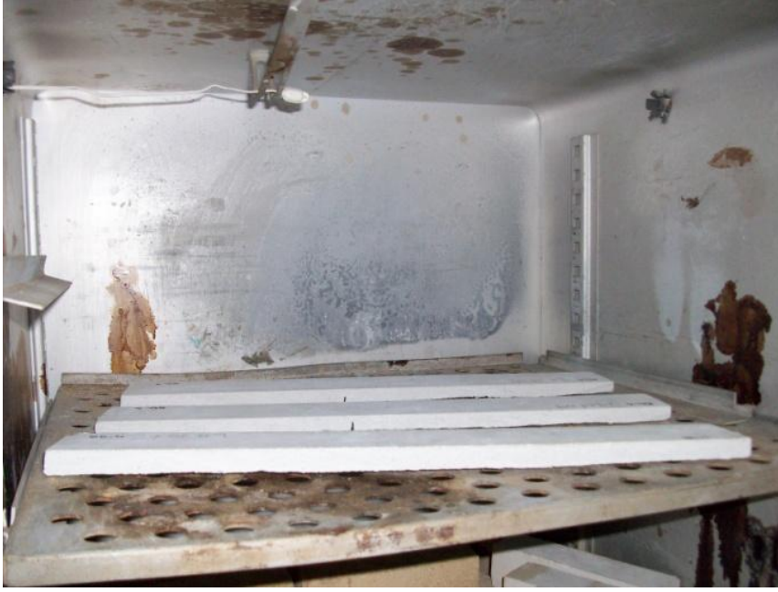
Şekil 4.22 : BD-4-5-6 numunelerinin etüvde bekletilmesi.
