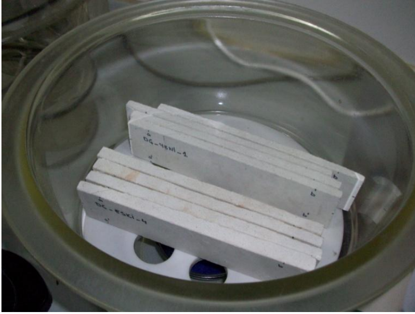
Şekil 4.15 : Numunelerin desikatörde soğutulması.
