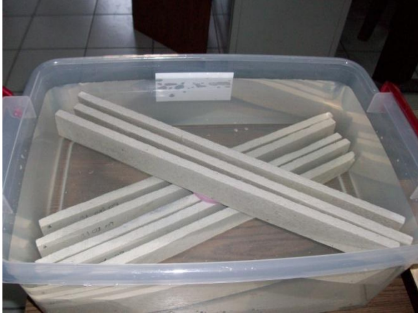
Şekil 4.10 : 20\pm 2^{\circ}\text{C} sıcaklıkta suda bekletilen “C” numuneleri.
