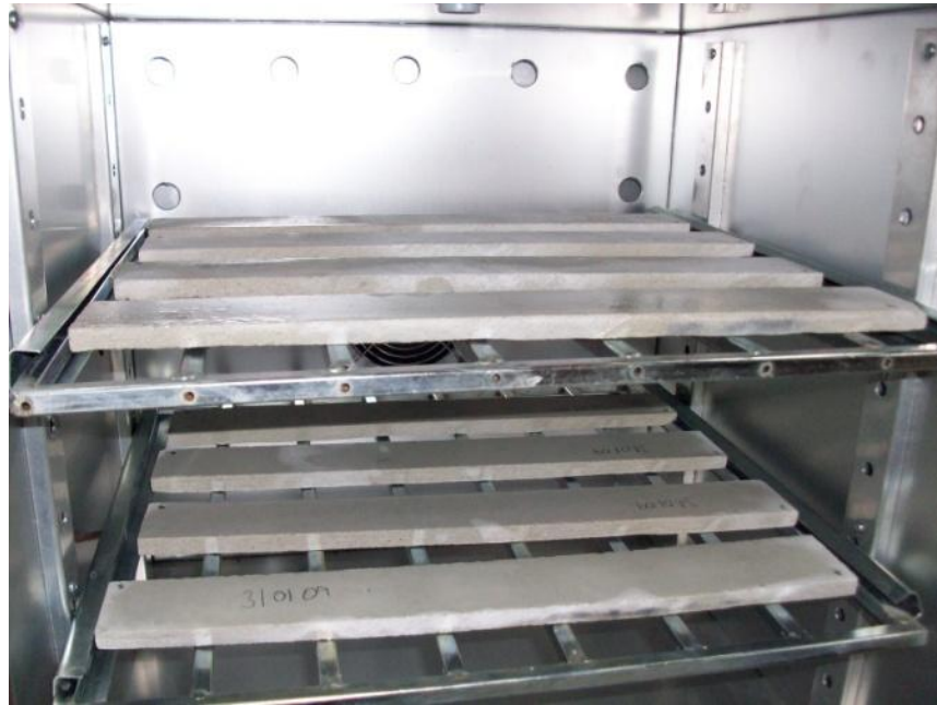
Şekil 4.11 : 70\pm 5^{\circ}\text{C} sıcaklıkta etüvde bekletilen “C” numuneleri.
