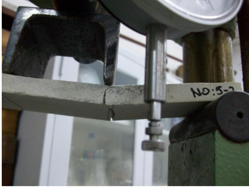
Şekil 4.24 : Kırılma sonrası C5-2 deney numunesi.
