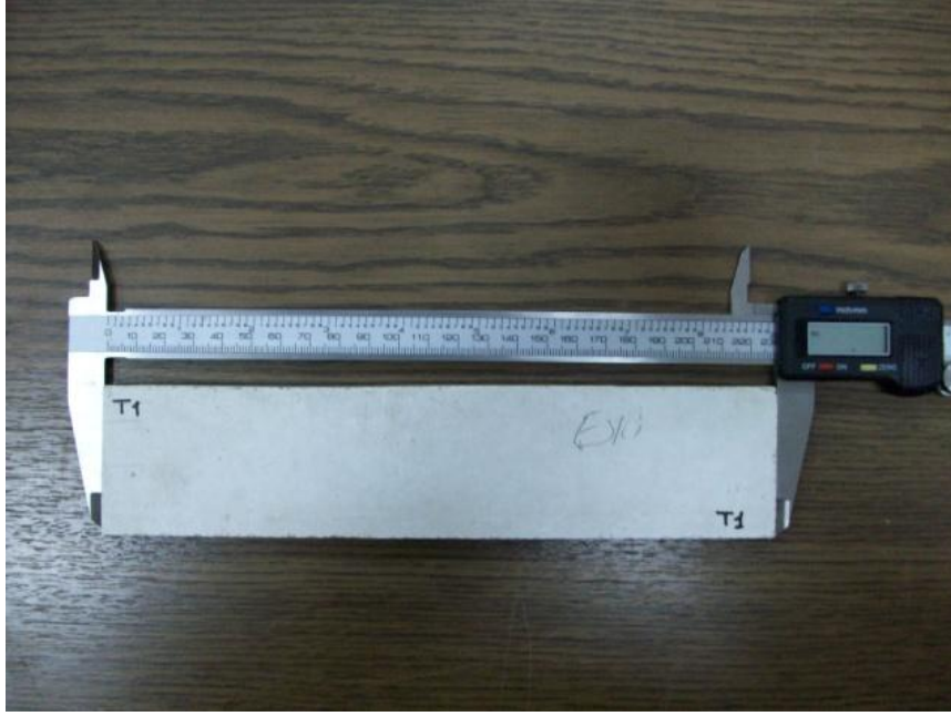
Şekil 4.2 : Deney numunelerinin boyutlarının kumpasla ölçülmesi.
