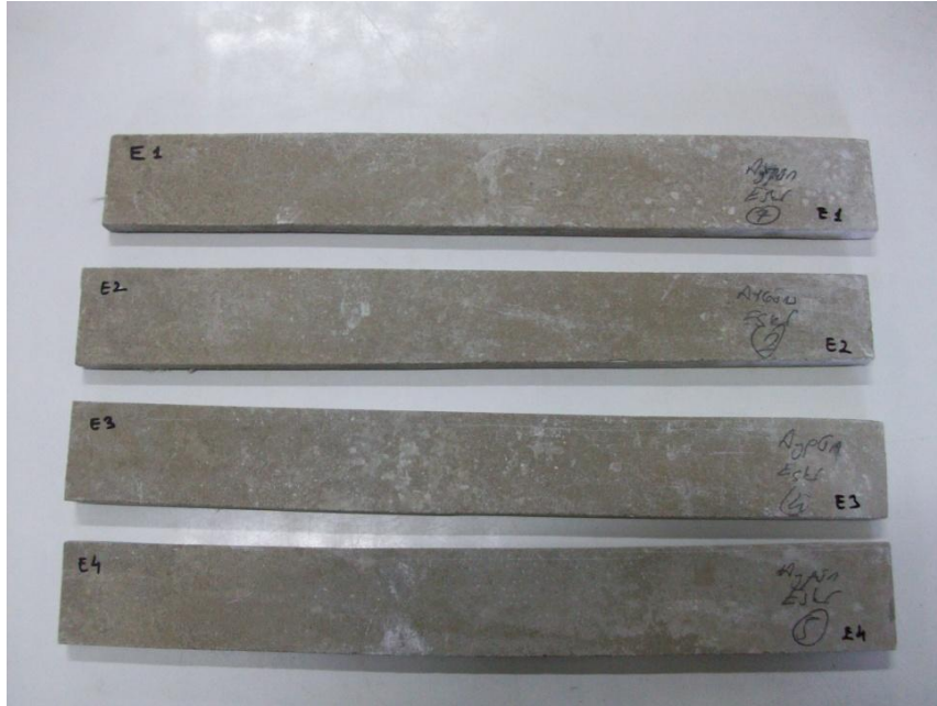
Şekil 4.12 : 20 devre sonunda deneye dahil edilen “E” numuneleri.
