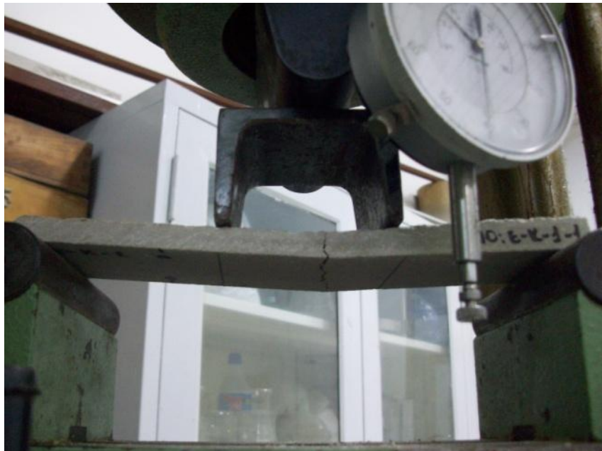
Şekil 4.25 : Kırılma sonrası EK1-1 deney numunesi.
