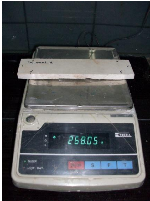
Şekil 4.16 : “DÇ-Yeni” ve “DÇ-Eski” numunelerinin tartım işlemi.
