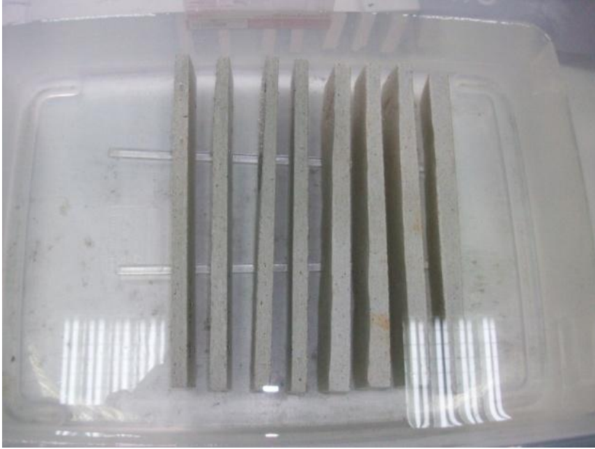
Şekil 4.18 : Numunelerin su dolu kap içerisinde bekletilmesi.
