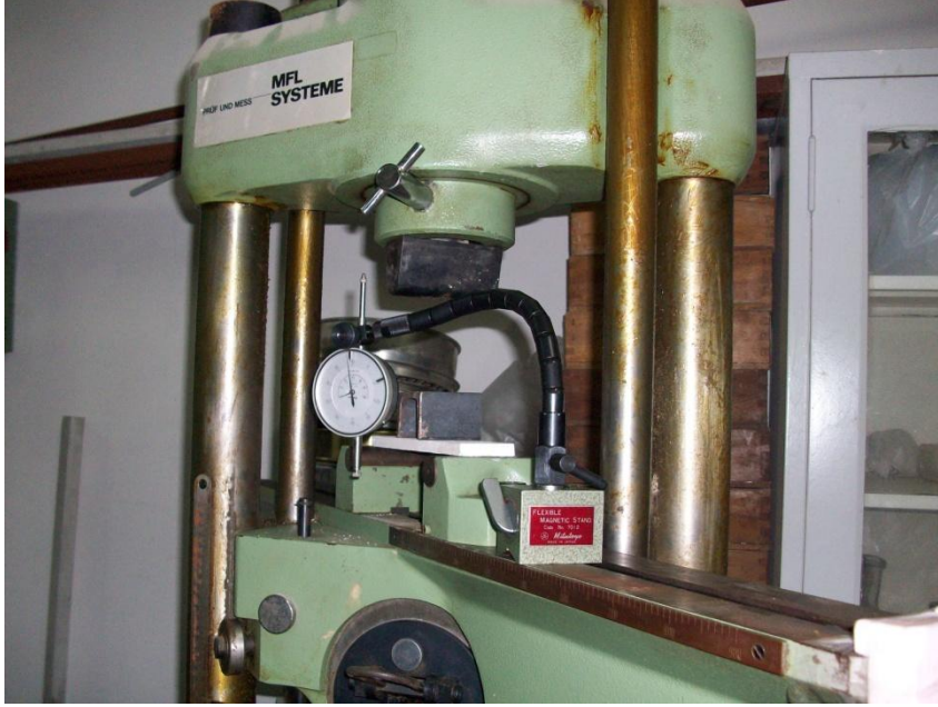
Şekil 4.23 : Eğilme deneyi düzeneği.
