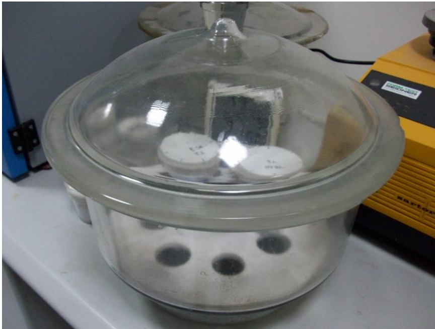
Şekil 4.9 : Numunelerin desikatör içerisinde muhafaza edilmesi.
