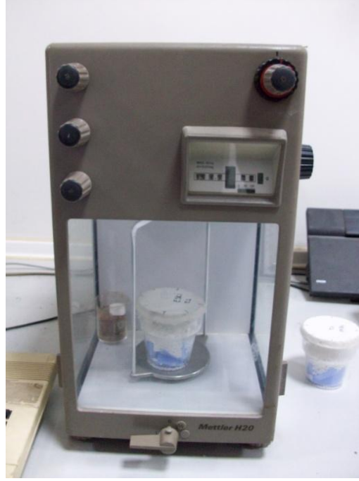
Şekil 4.8 : E2 ve Y2 numunelerinin tartılması.
