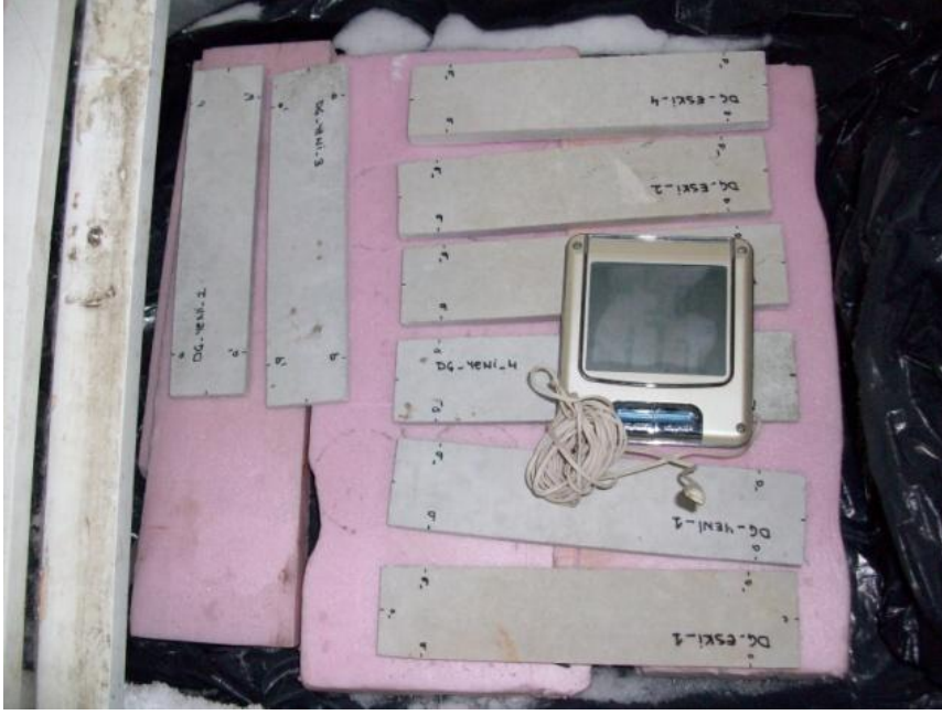
Şekil 4.17 : Numunelerin soğuk hava dolabında bekletilmesi.
