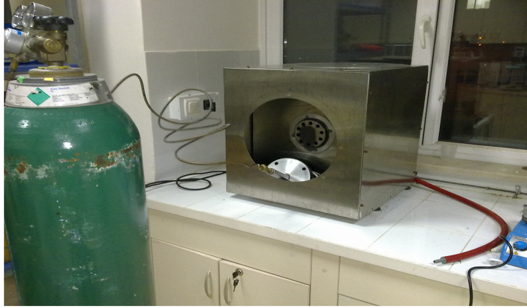
Şekil 3.10. Tüp temizleme fırını
