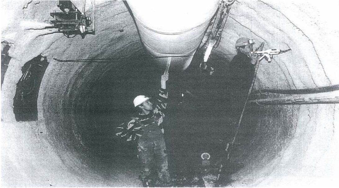
Şekil 5.6 : Bant uzama ölçer ile noktalar arası ölçüm yapılışı
