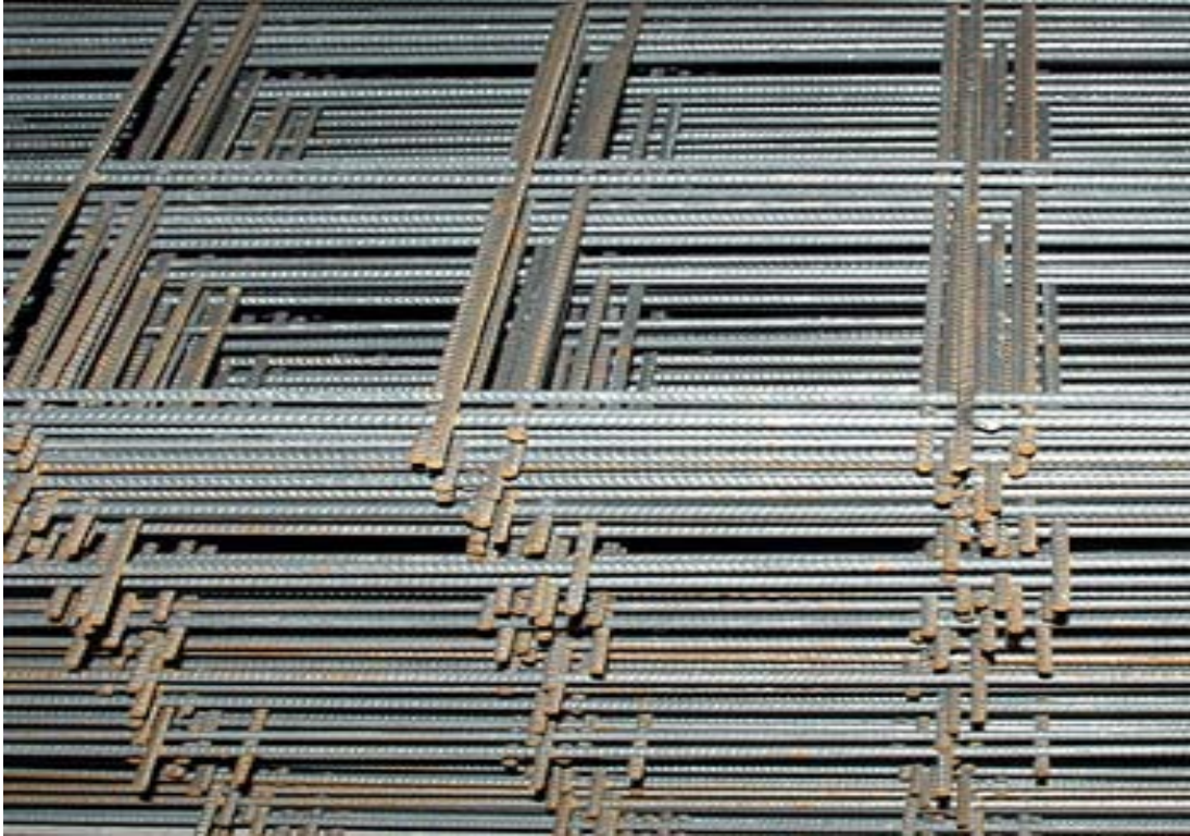
Şekil 6.11 : Çelik hasır donatı çubukları ve karelajı
