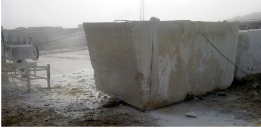
Şekil 3. 6. Mermer ocaklarında uygulanan sayalama işlemi (Can Mermer, Isparta)
