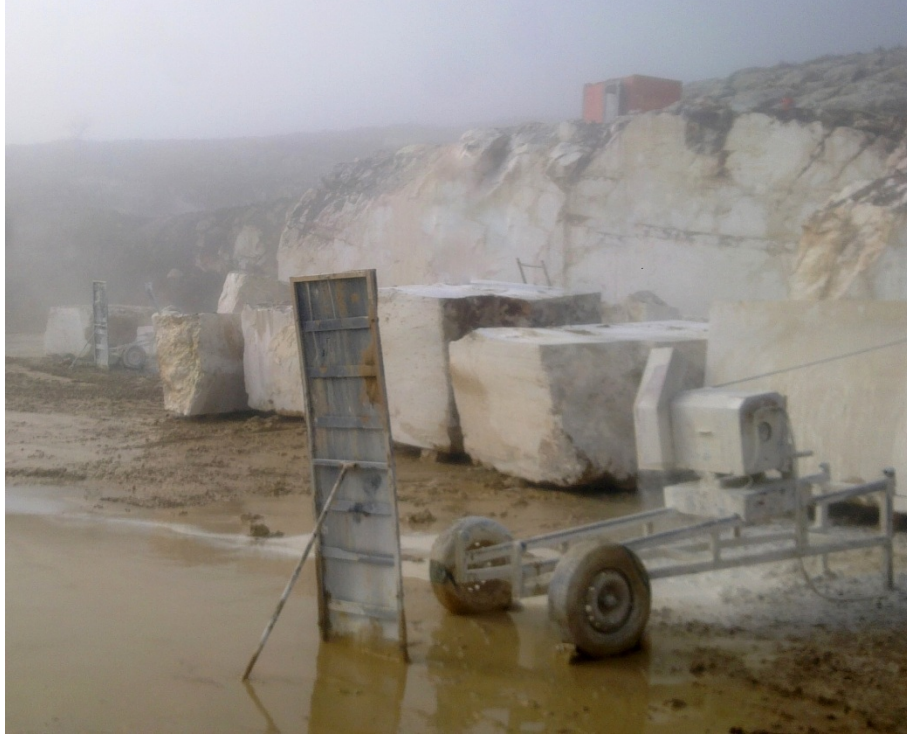
Şekil 3. 1. Mermer ocağı tel kesme yöntemi (Can Mermer, Isparta)
