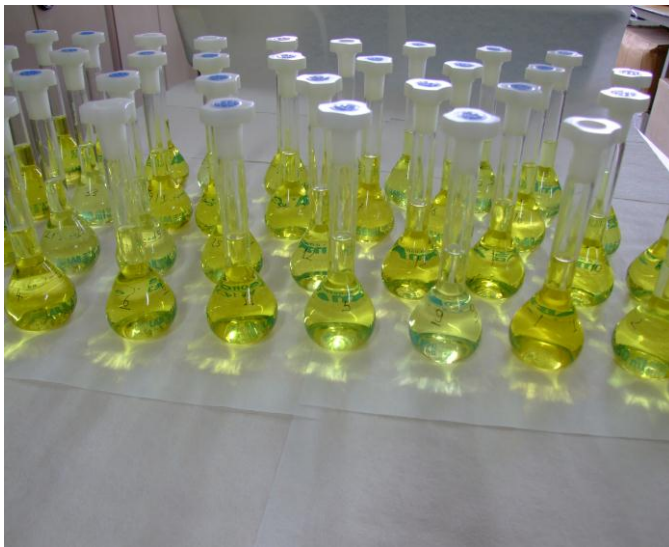
Şekil 2.6. Örneklerin ICP analizine hazırlanması
