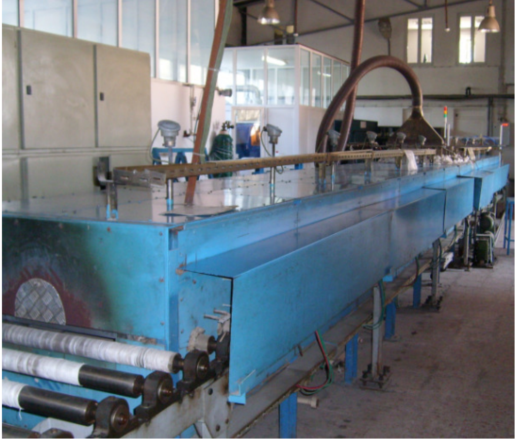
Şekil 5.12 : Pişme küçülmesi tayini için kullanılan fırın.
