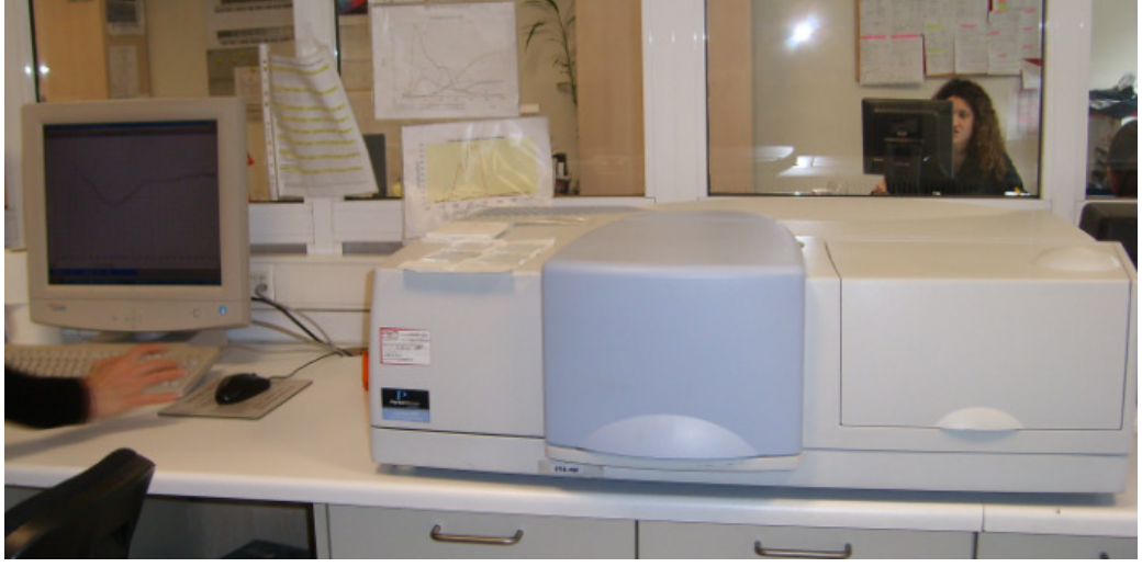
Şekil 5.14 : Pişme rengi belirlemek için kullanılan cihaz.
