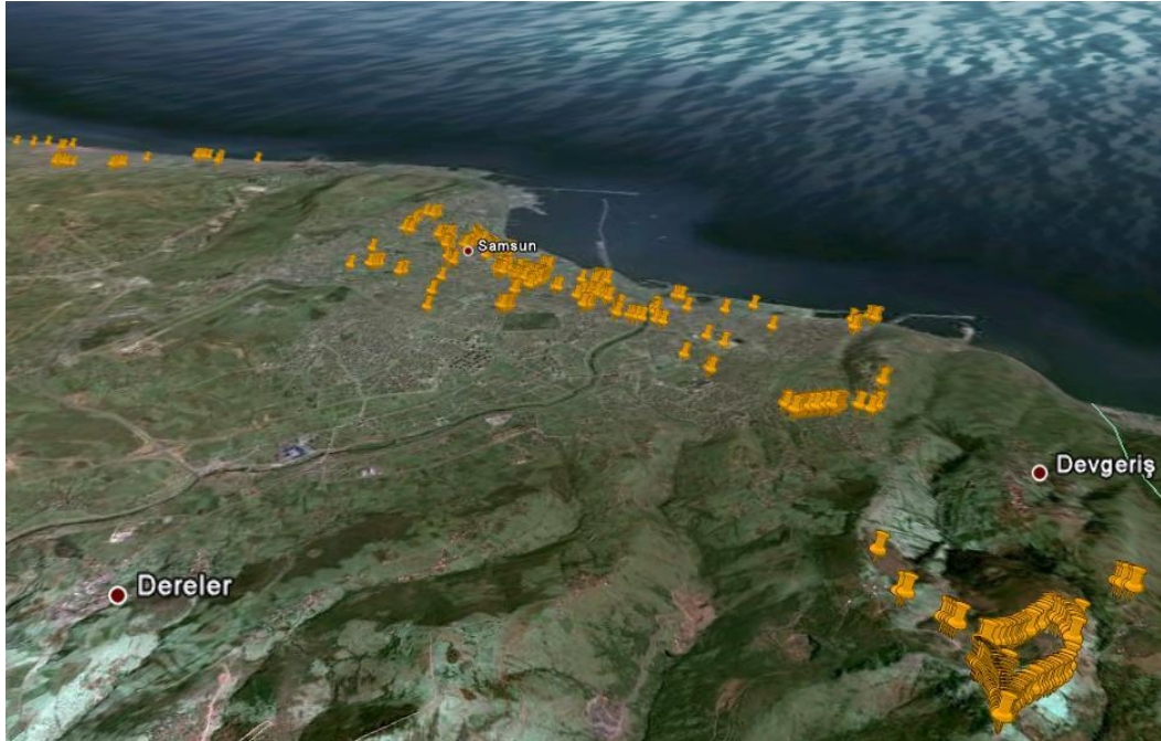
Şekil 4.37. EMR 300 ile Elektrik Alan Şiddeti 1,5 V/m ile 7V/m arasında ölçüm elde edilen noktalar (3B) (906 adet kayıt)
