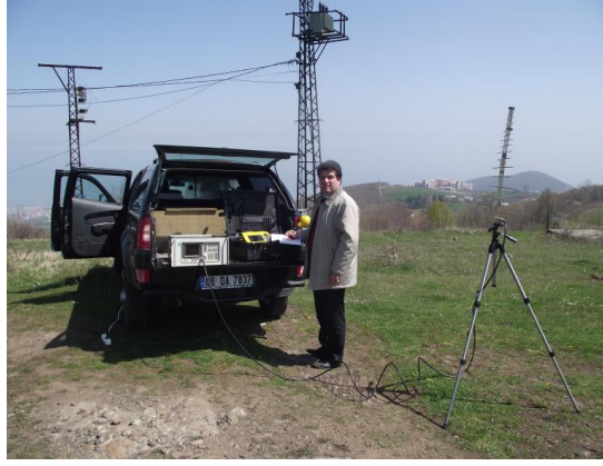
Şekil 4.15. Spektrum Analizör kullanılarak yapılan ölçümler
