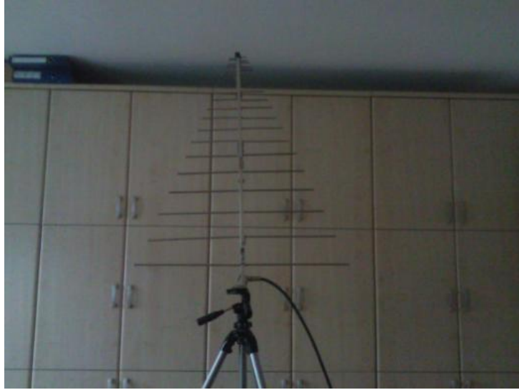
Şekil 3.14. Yatay Polarizasyon Ölçümleri z eksenini
