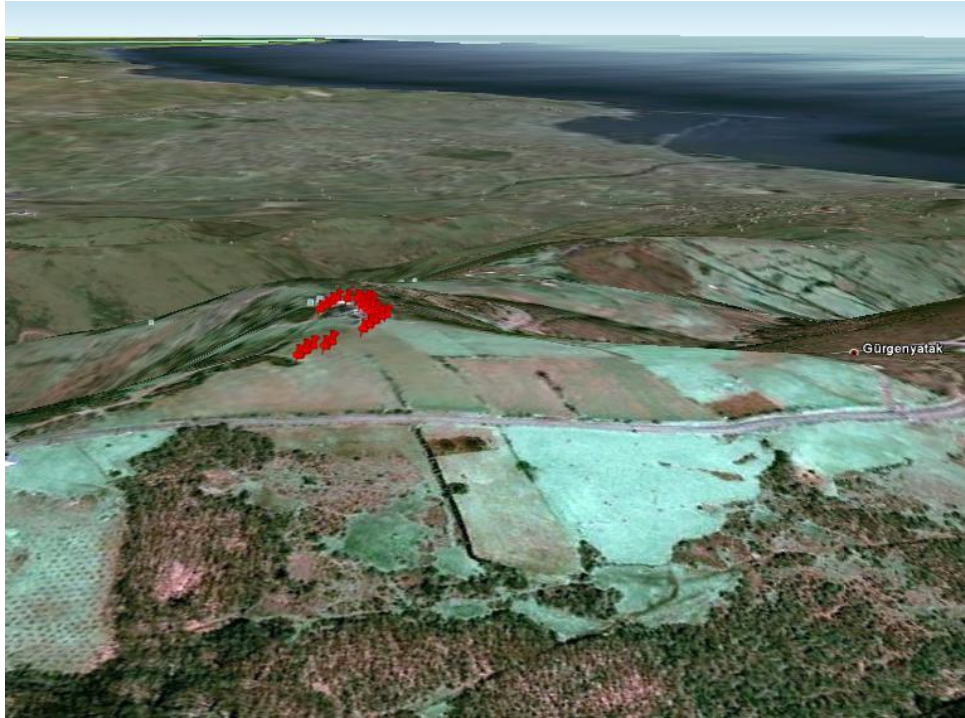
Şekil 4.39. EMR 300 ile Elektrik Alan Şiddeti 7V/m üzerinde ölçüm elde edilen noktalar (3B) (48 adet kayıt)
