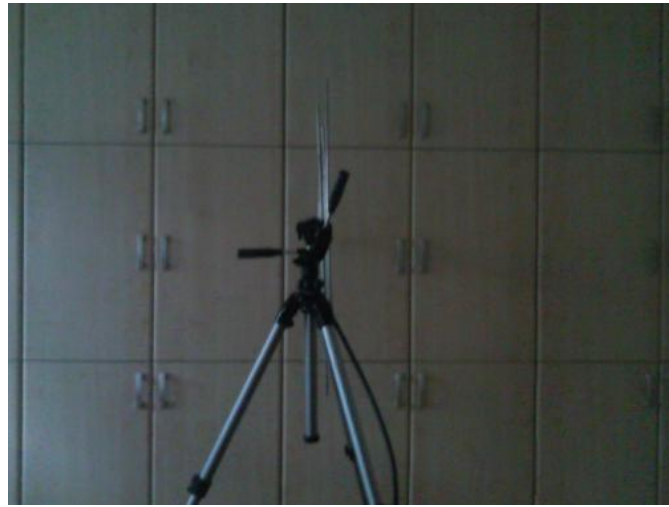
Şekil 3.10.Düşey Polarizasyon Ölçümleri y eksen
